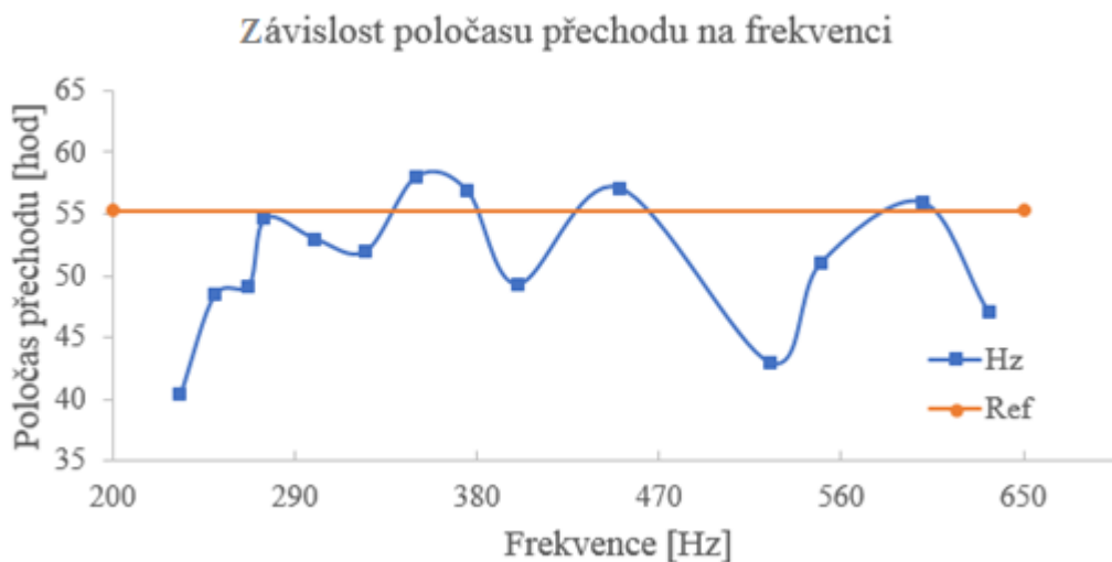
Graf 19 Závislost poločasu přechodu na frekvenci (rozsah Hz)
