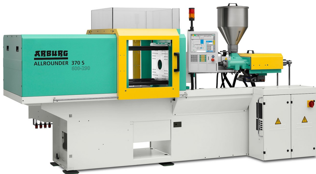
Obr. 40 Vstřikovací stroj typ Allrounder 370 S [25]
