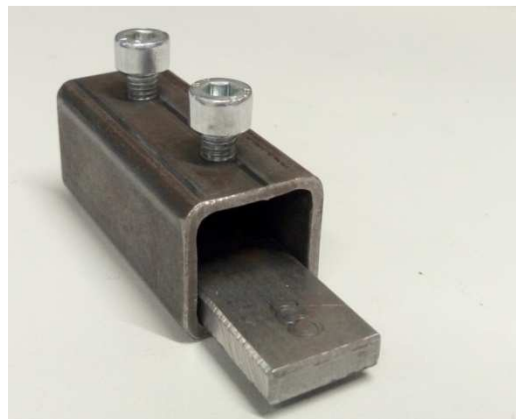
Obr. 56. Přípravek proti vybočení zkušební tělesa [18]
