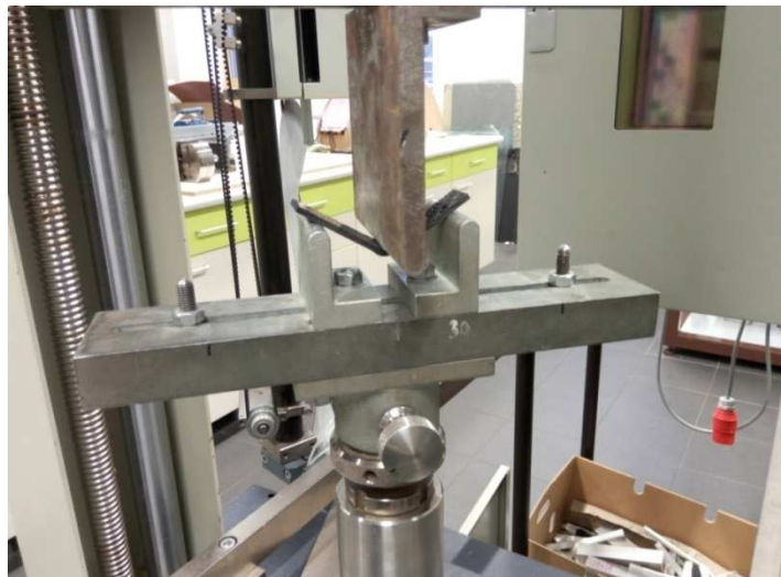
Obr. 66. Fotografie ohybové zkoušky vzorku uhlíkového kompozitu [18]
