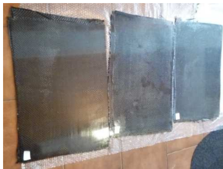
Obr. 44. Kompozitní desky s uhlíkovou výztuží pro výrobu vzorků [18]
