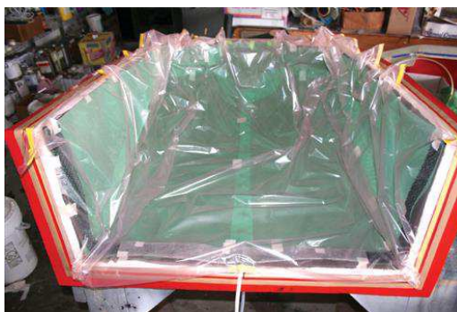
Obr. 19. Vakuová folie při výrobě dílu [13]
