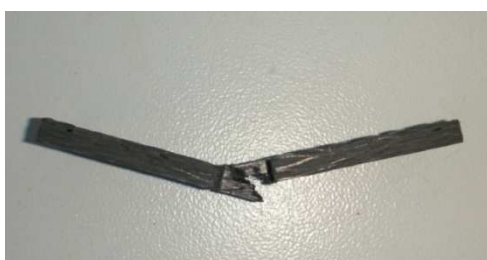
Obr. 64. Lom vzorku vhodný pro vyhodnocení měření [18]
