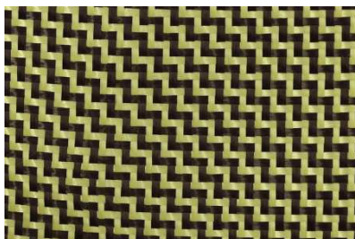
Obr. 17. Hybridní tkanina uhlík a aramid s keprovou vazbou [11]
