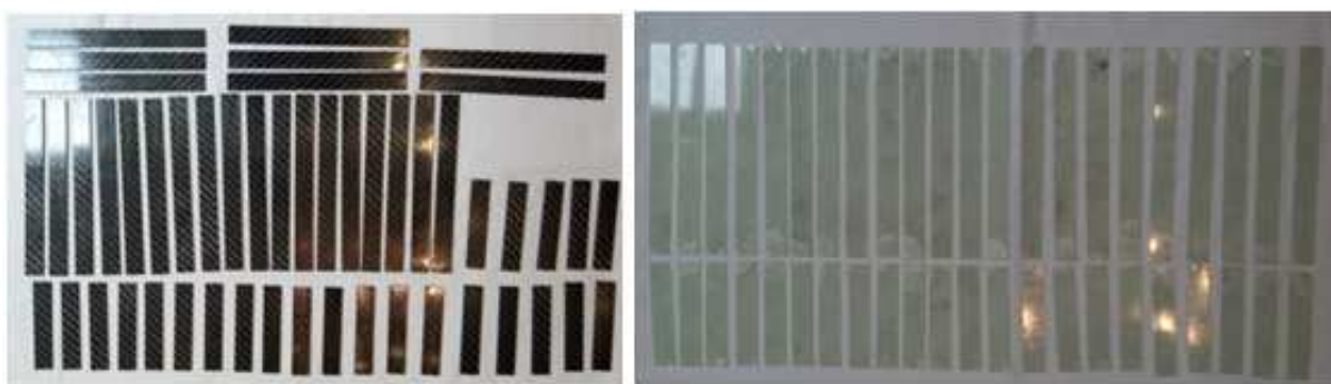
Obr. 45. Nařezané zkušební vzorky (z leva): uhlíková tkanina, skelná tkanina [18]
