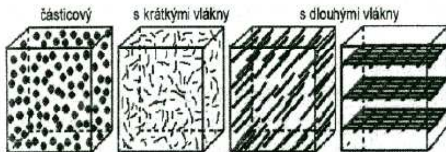
Obr. 1. Základní dělení kompozitních materiálů podle geometrické formy výztuže [4]
