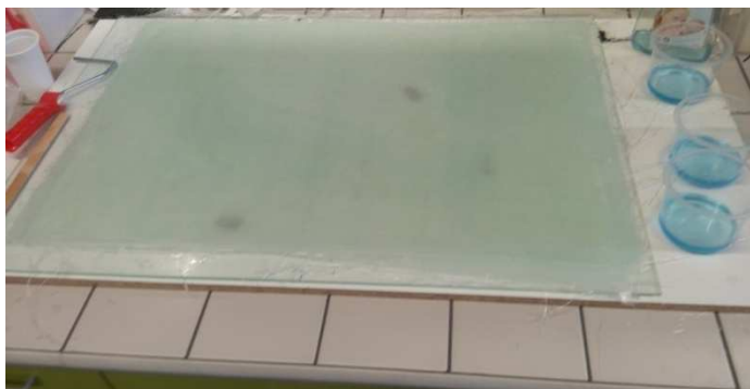
Obr. 40. Deska z 8 vrstev skelné tkaniny [18]
