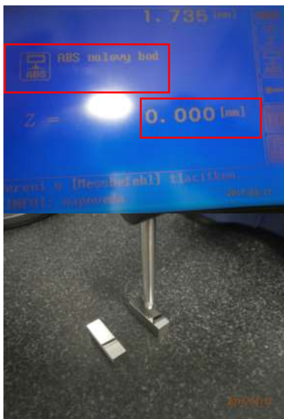
Obr. 44 Nastavení nulového bodu ABS na koncovou měrku
