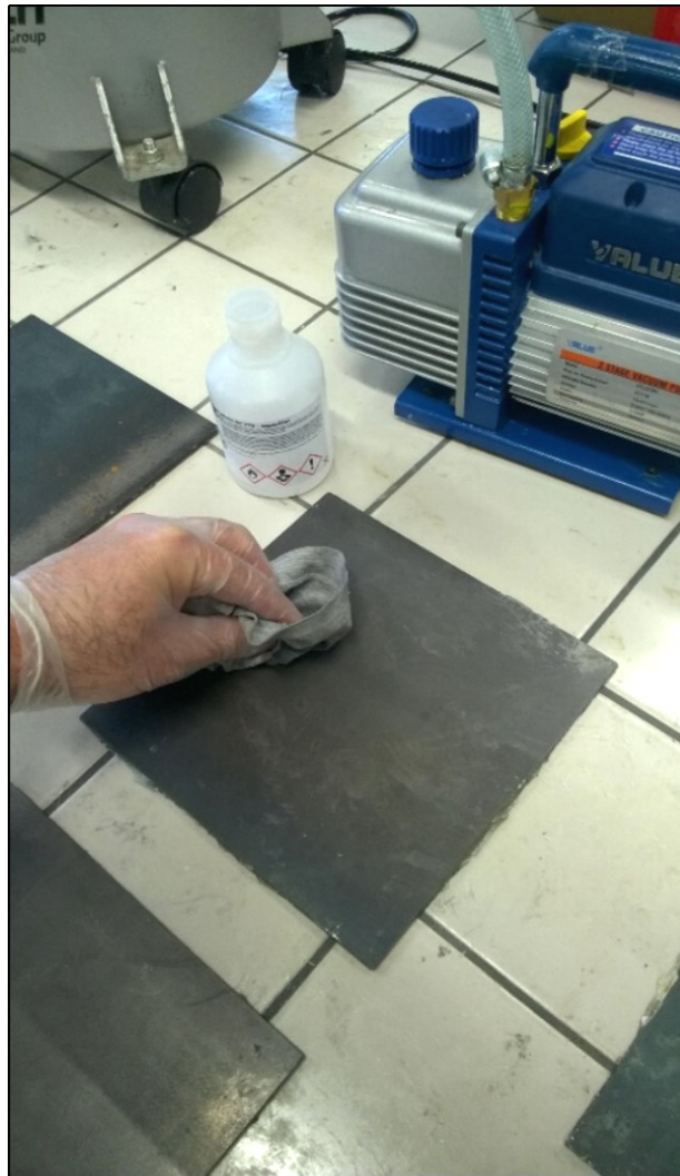
Obr. 38 Úprava povrchu formy separátorem Frekote
