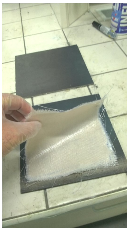
Obr. 40 Prepreg s šesti vrstvami skelné tkaniny před uložením do formy
