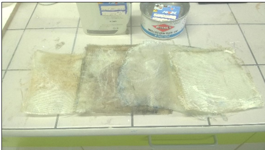
Obr. 46 Vadné polymerní vzorky – z důvodu slepení formy a nedostatečné teploty vytvrzování
