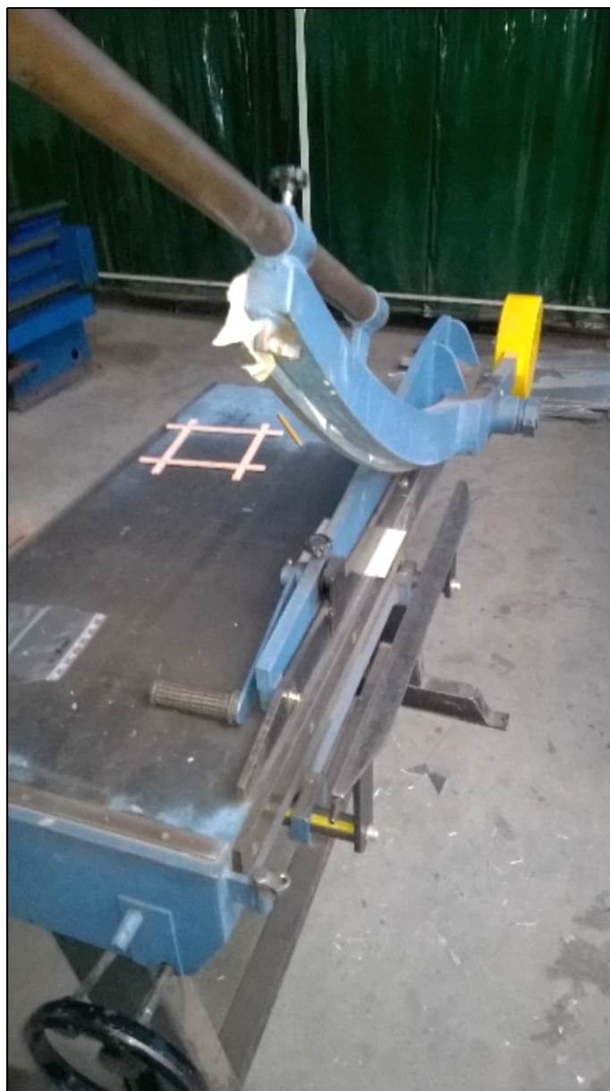
Obr. 44 Úprava zkušebních vzorků na požadovaný rozměr
