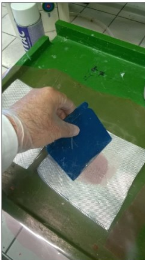
Obr. 36 Prosyčení skelných vláken polymerní matricí: a) prosycování vlákna pryskyřicí, b) prosycená tkanina - prepreg
