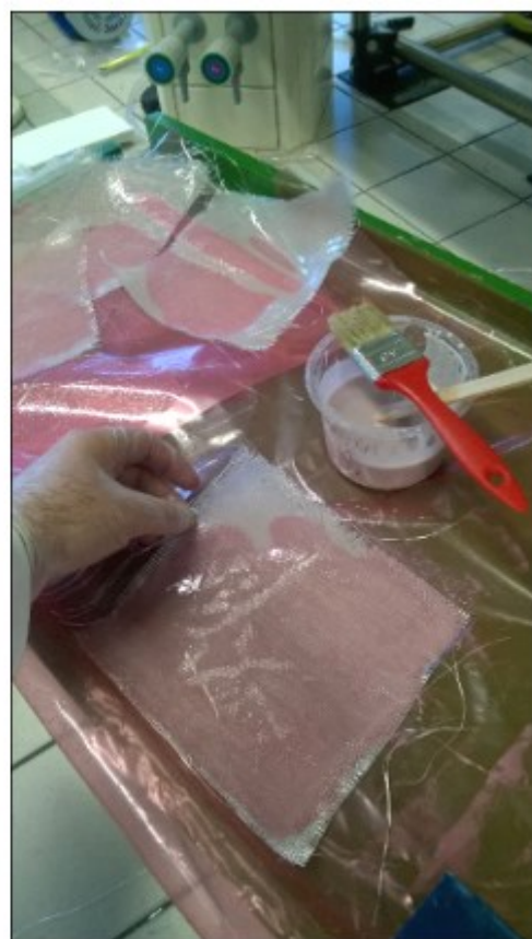
Obr. 36 Prosyčení skelných vláken polymerní matricí: a) prosycování vlákna pryskyřicí, b) prosycená tkanina - prepreg
