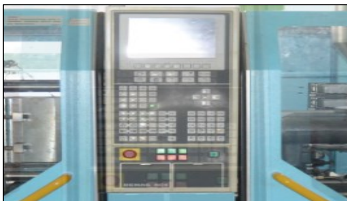
Obr. 5. Ovládací panel vstřikovacího stroje DEMAG
