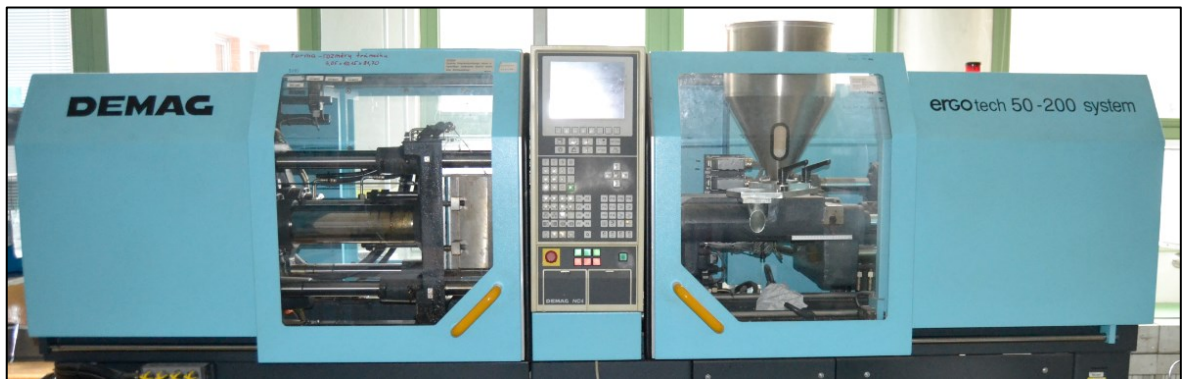
Obr. 13. Vstřikolis DEMAG, ergotech 50-200 system
