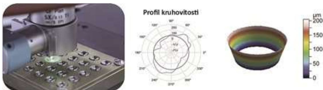
Obrázek 7: Systém CCI zajišťuje kompletní automatickou kontrolu sériové výroby
