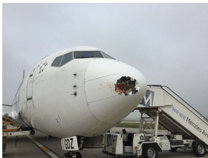
Obr. 14 Letoun B737 poškozený po srážce s ptákem [25]
