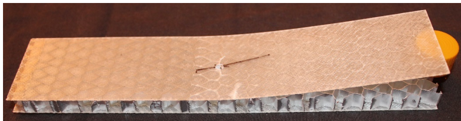
Obr. 51 Vzorek s trhlinou a s částečnou delaminací
