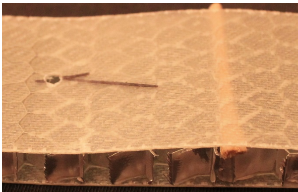
Obr. 57 Vzorek bez trhliny, s lokální delaminací
