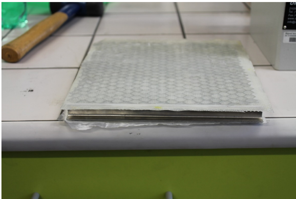
Obr. 24 Dokončený model křídélka pro zkoušky
