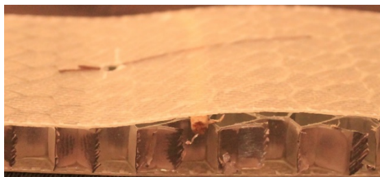
Obr. 58 Vzorek s trhlinou a lokální delaminací
