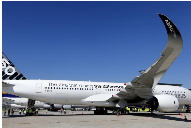
Obr. 2 Konce křidel (sharklets) letounu Airbus A350 [6]
