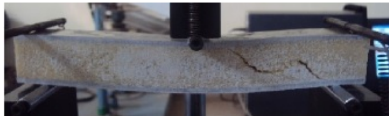
Obr. 9 Sendvič s pěnovým jádrem poškozený únavou [21]
