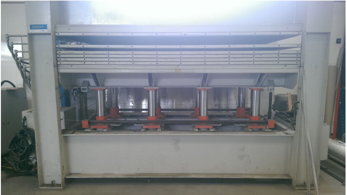
Obr. 31 Lisování vzorku sendviče
