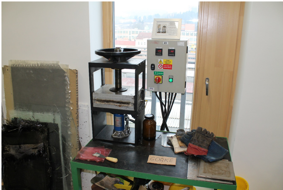
Obr. 29 Laboratorní vulkanizační lis
