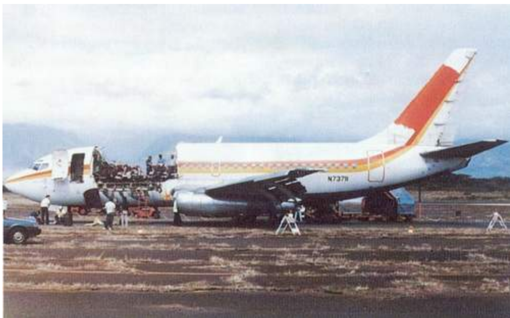
Obr. 7 Boeing B737-200 let 243 Aloha Airways poškozený vlivem únavy materiálu [16]
