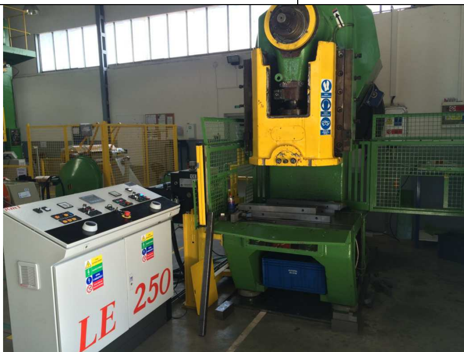
Obr. 42 Stroj použitý při zkoušce postupového nástroje
