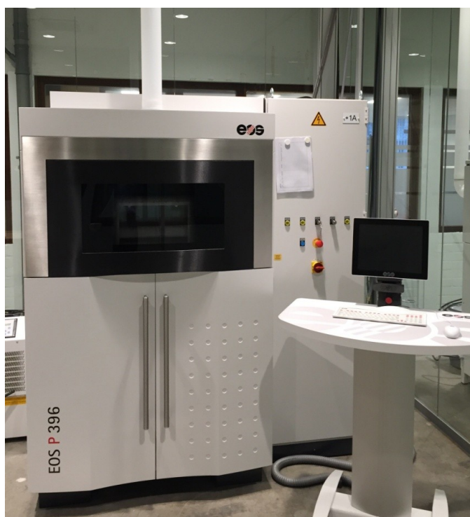
Obr. 26. 3D tiskárna EOS P396.
