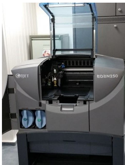
Obr. 27. 3D tiskárna OBJET EDEN 250.
