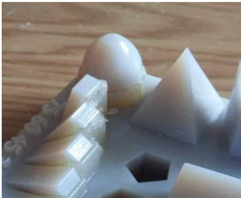
Obr. 29. Detail tělesa s neodstraněným podpůrným materiálem.
