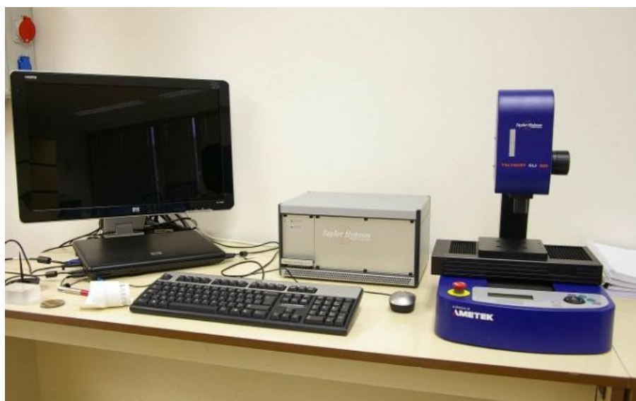
Obr. 62. 3D drsnoměr Taylor Hobson Talysurf CLI 500.
