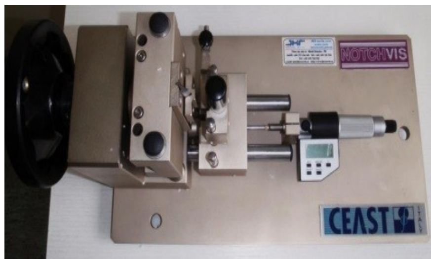
Obr. 40. Vrubovací zařízení CEAST.
