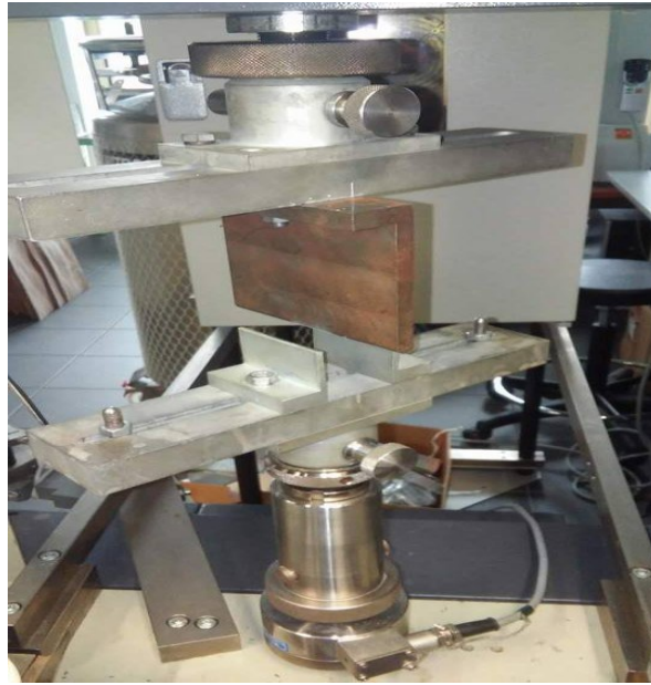
Obr. 35. Přípravek pro zkoušku ohybem.
