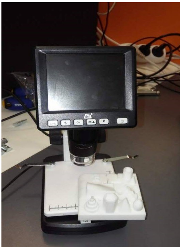
Obr. 82. Mikroskopová kamera DigiMicro 5.0.
