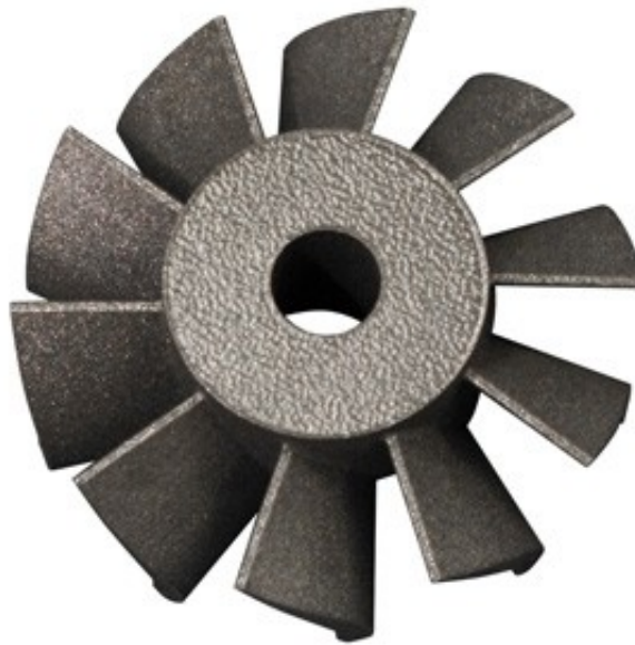
Obr. 12. Příklad součásti vyrobené metodou DMLS [11].
