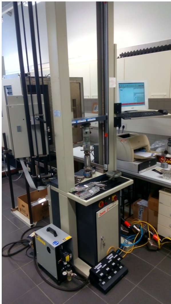
Obr. 8 Trhací stroj Zwick 1456 nastaven pro ohybovou zkoušku
