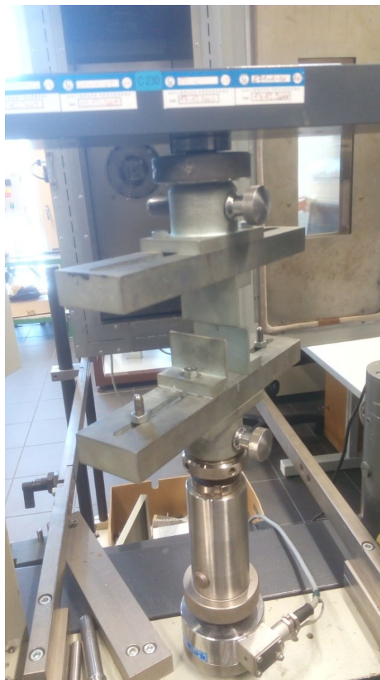
Obr. 26 Nastavení čelistí na ohybovou zkoušku
