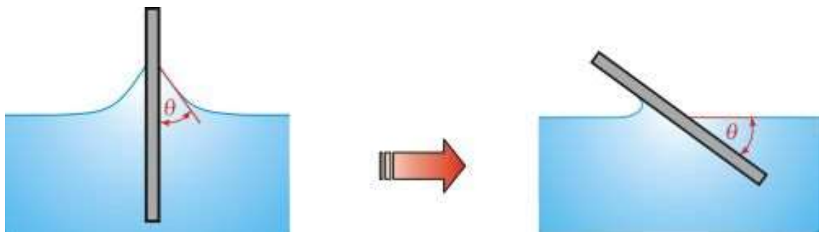
Obr. 11. Měření úhlu smáčení druhou metodou [12]
