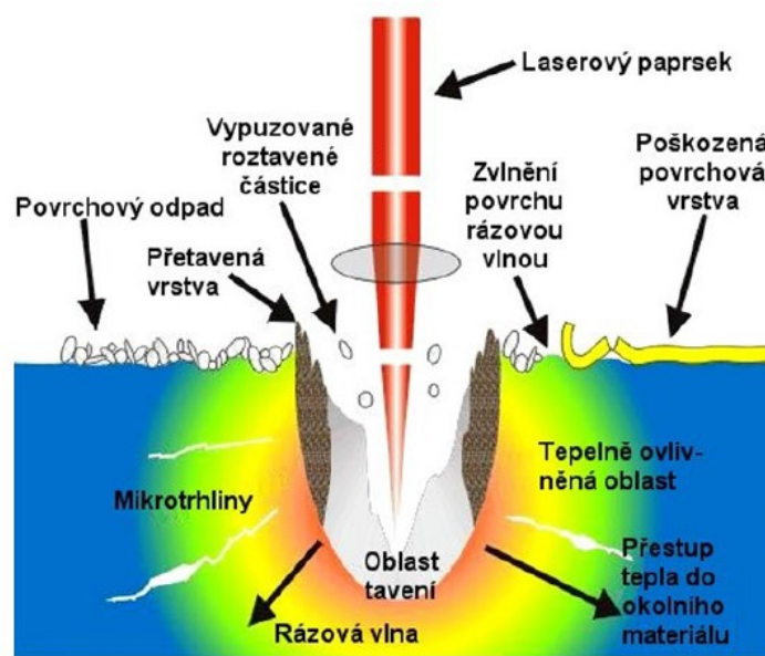
Obr. 13. Pracovní proces laseru [13]
