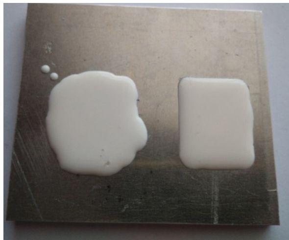
Obr. 45. Matrice zalité tekutým latexem
