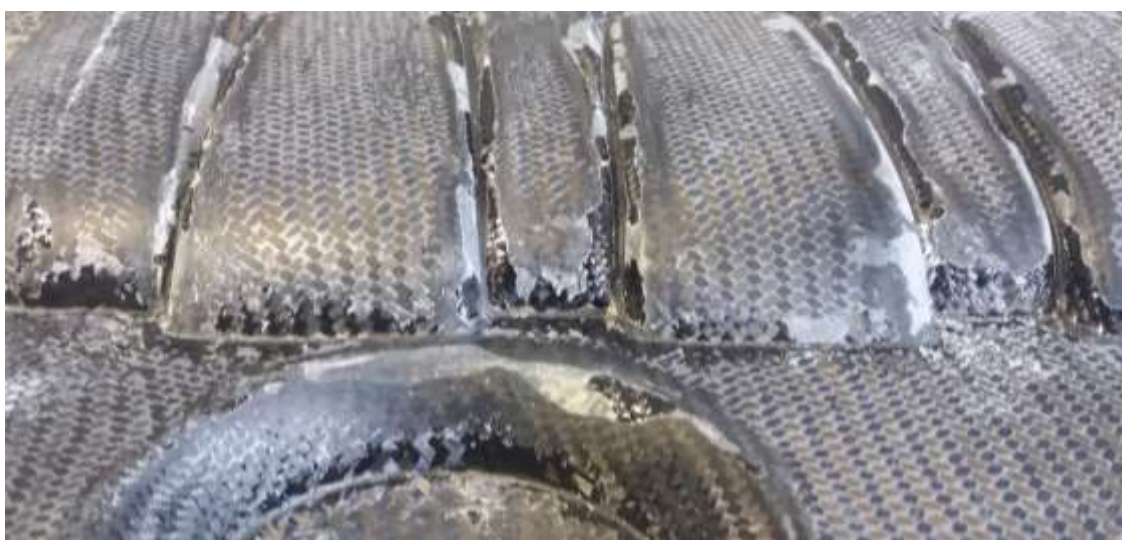
Obr. 48 Vzniklé vady po odformování – 2. způsob
