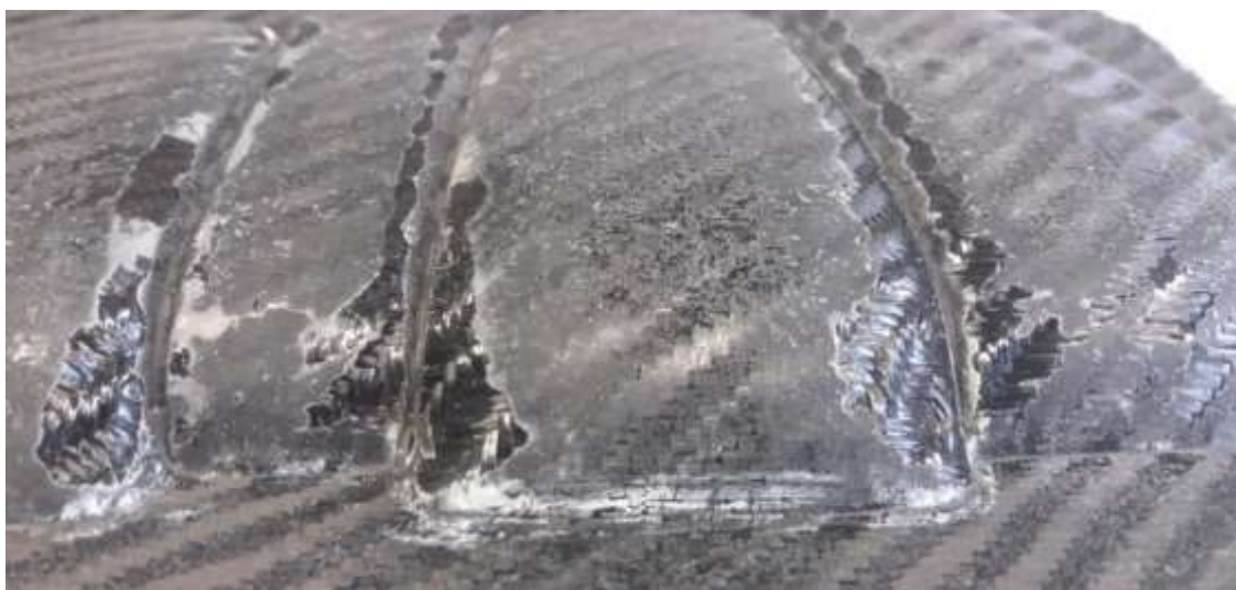
Obr. 47 Vzniklé vady po odformování – 1. Způsob
