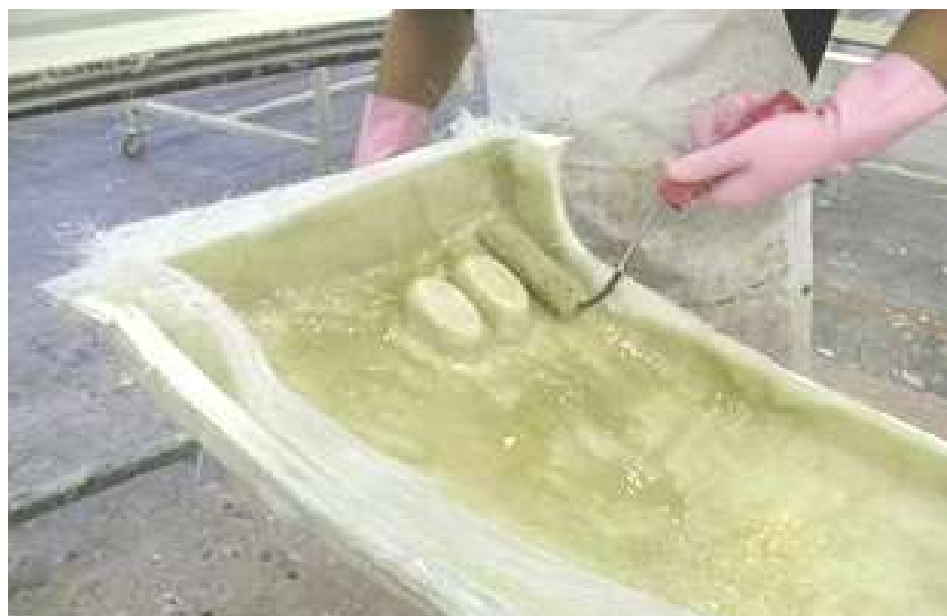
Obr. 16 Výroby formy ruční laminací [26]
