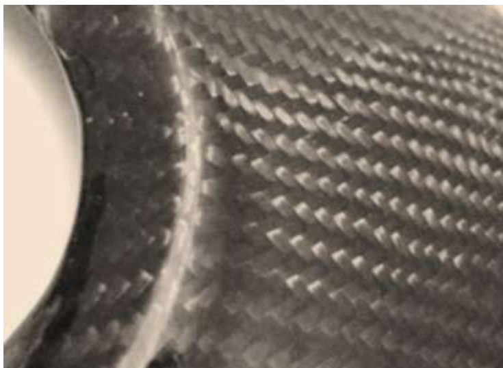
Obr. 52 Detail uhlíkové tkaniny na finálním výrobku
