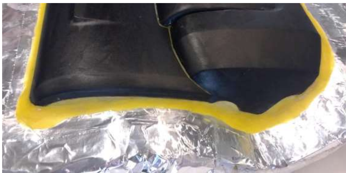
Obr. 40 Použití tvarovací plastelíny
