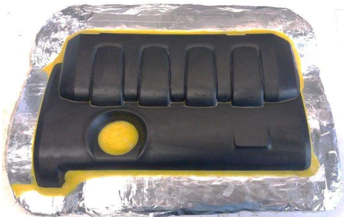
Obr. 41 Nanesení separačního vosku
