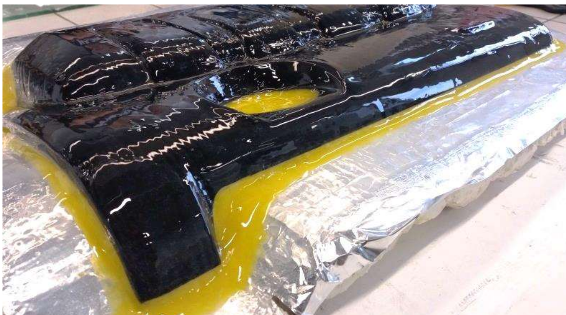
Obr. 42 Díl potřený gelcoatem
