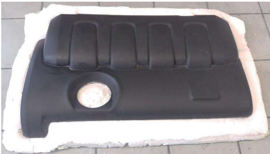
Obr. 39 Vyrovnání povrchu stavební sádrou
