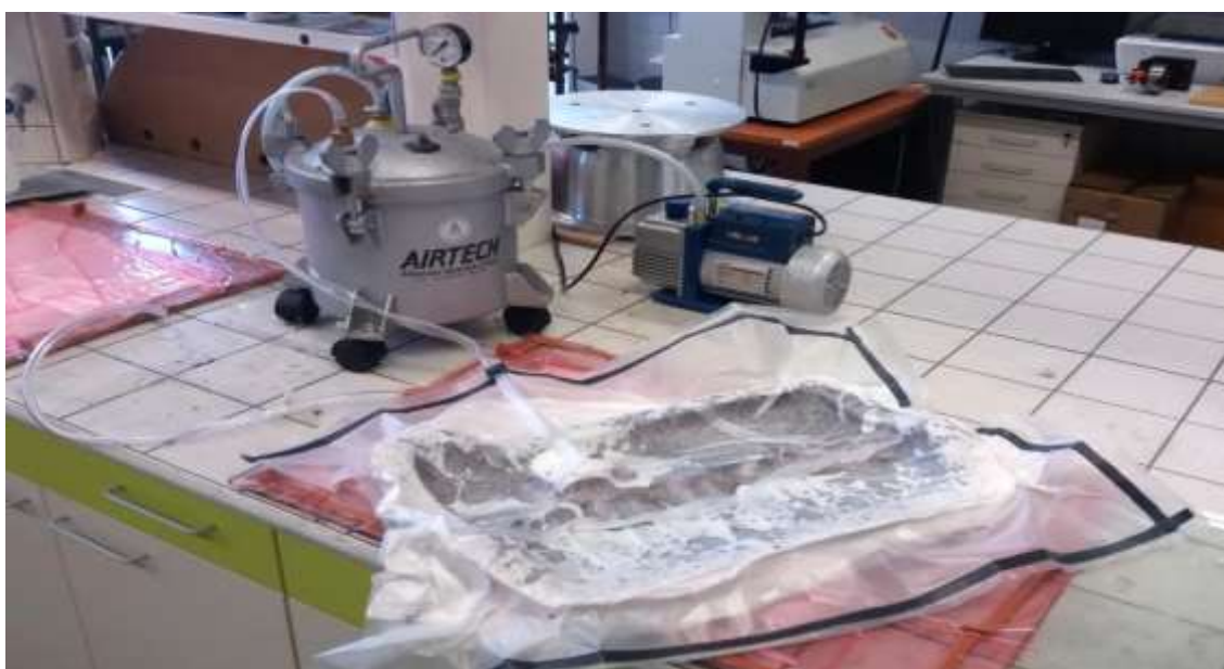
Obr. 46 Výroba za pomoci vakuové infuze
