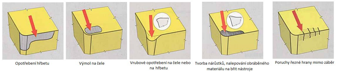
Obr. 20. Možnosti opotřebení nástroje [19]
