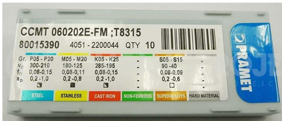
Obr. 21. Příklad značení předepsaných řezných podmínek výrobcem [14]
