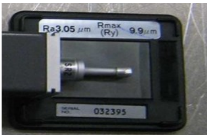
Obr. 39. Kalibrace drsnoměru Mitutoyo SJ-301
