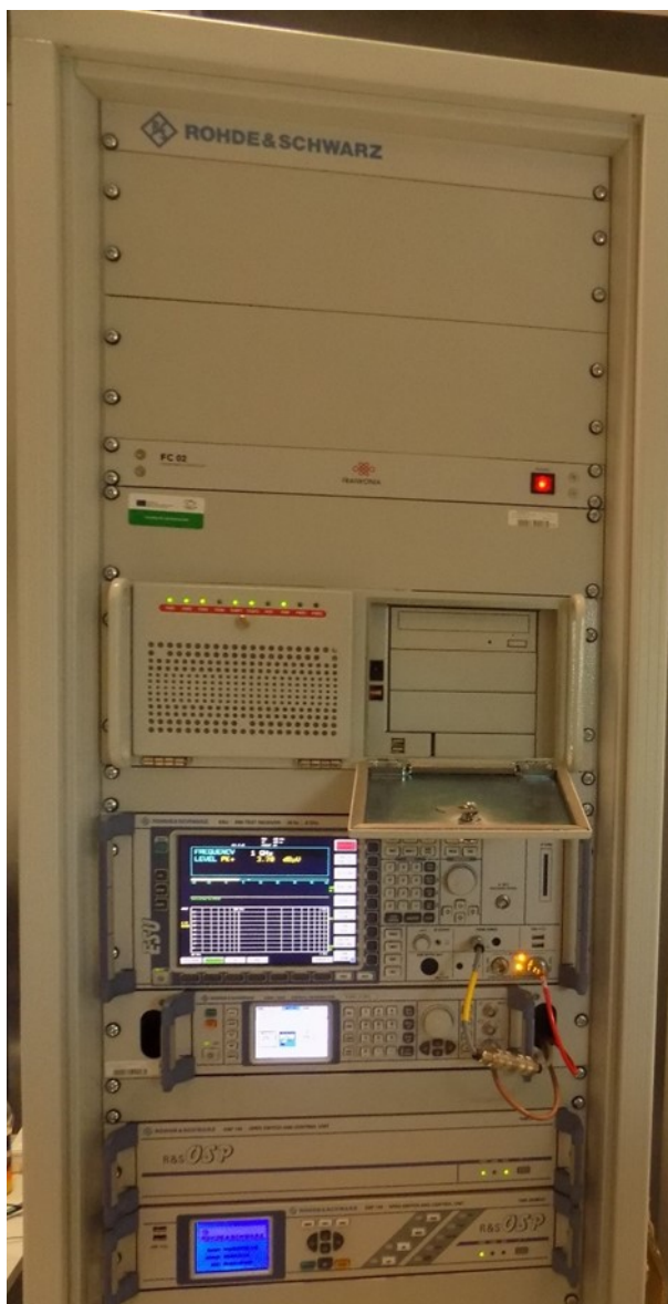
Obr. 24: Řídící počítač s generátorem, EMI přijímačem a zesilovači
