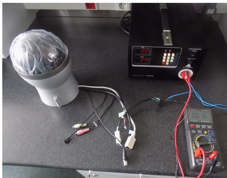
Obr. 38: Zapojení ampérmetru na přeměření odběru kamery
