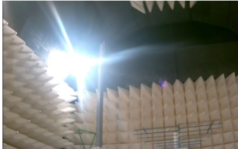
Obr. 43: Screenshot záznamu kamery při testu odolnosti – horizontální polarizace antény
