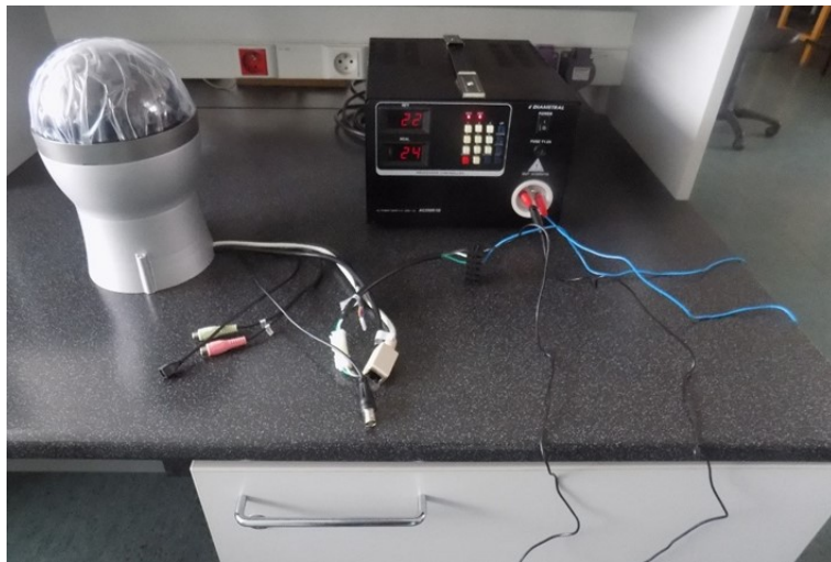
Obr. 37: Zobrazení napájení kamery pomocí zdroje Diametral
