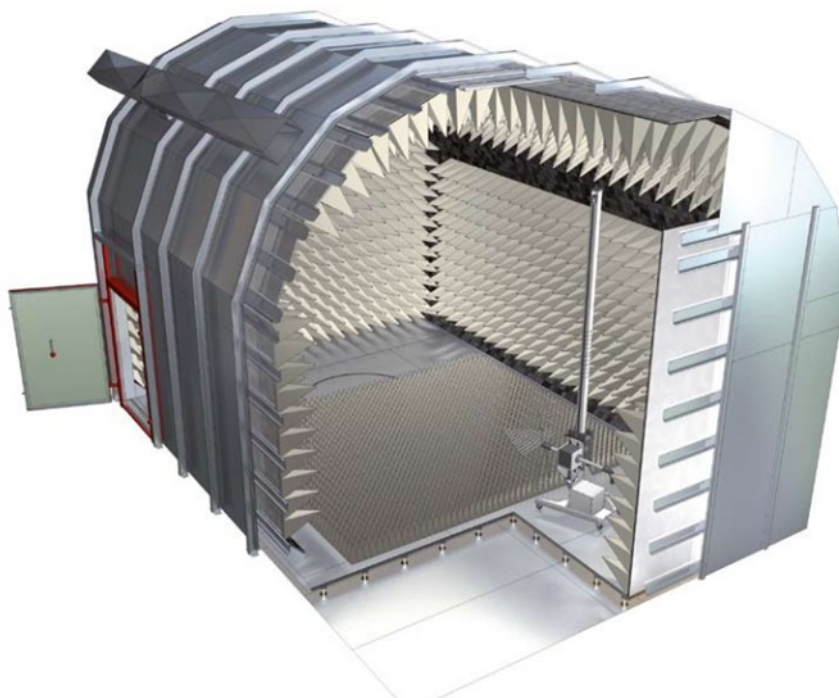
Obr. 18: Bezodrazová komora Frankonia SAC-3 Plus S [19]
