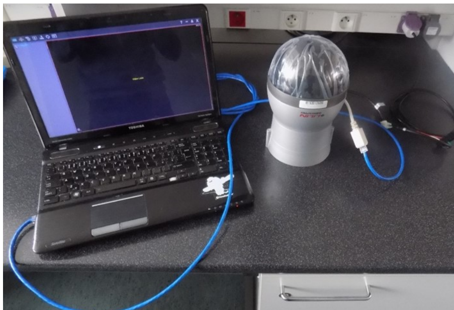
Obr. 31: Zapojení kamery LILIN do notebooku, napájeno ze sítě
