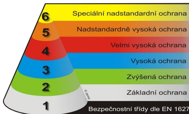
Obrázek 1. Bezpečnostní třídy dle normy EN 1627. [3]
