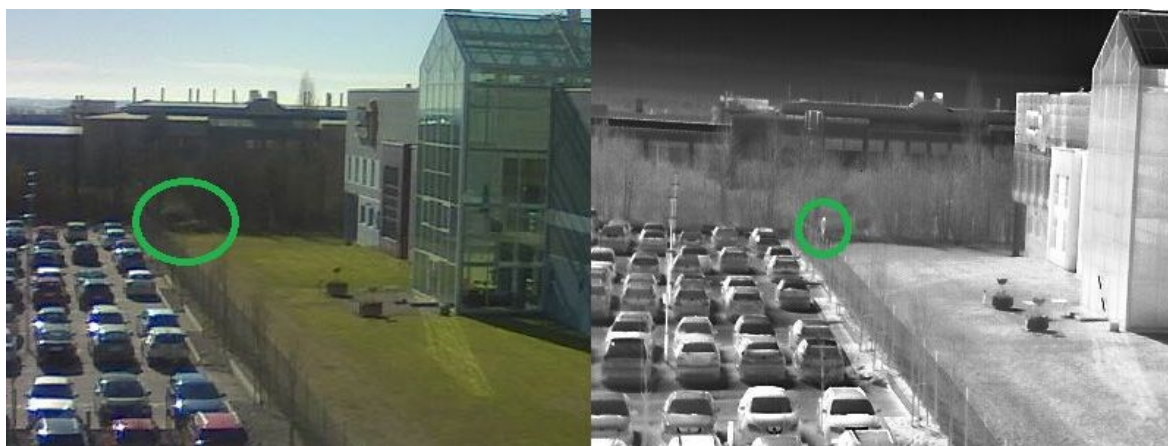
Obrázek 39. Porovnání klasické kamery a termální při zhoršených světelných podmínkách.
