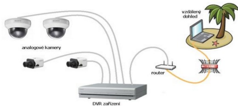
Obrázek 20. Analogový kamerový systém VDS s DVR. [28]
