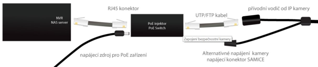
Obrázek 21. Přenosová trasa u IP kamerového systému. [38]
