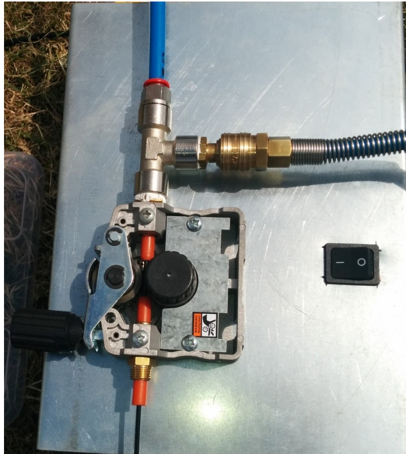
Obr. 33. Detail podávača zafukovacieho zariadenia.
