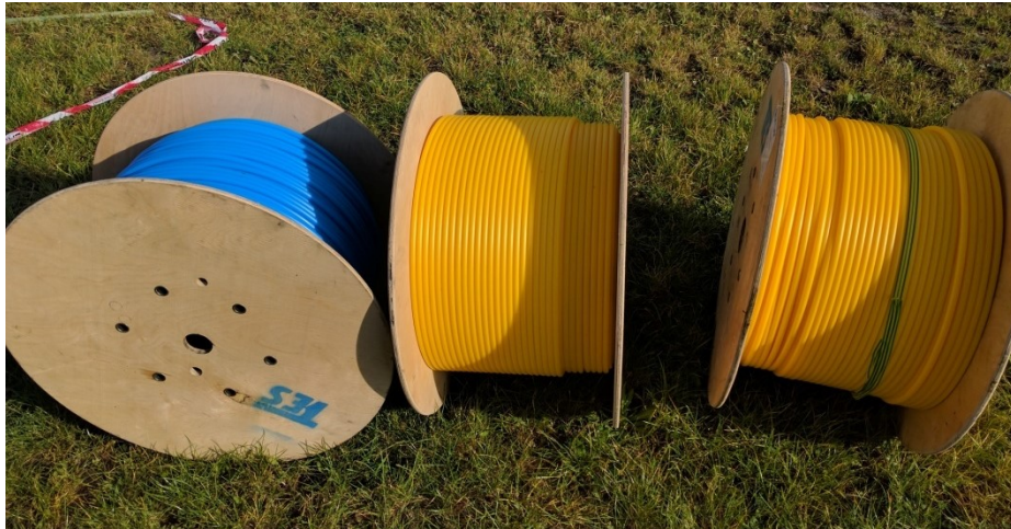
Obr. 26. Mikrotrubičky použité vo výkope.
