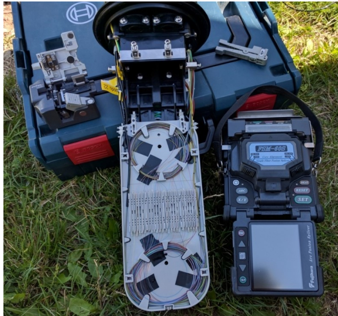
Obr. 36. Ukážka zvaracieho automatu Fujikura S60 a zemnej spojky so zvarmi.
