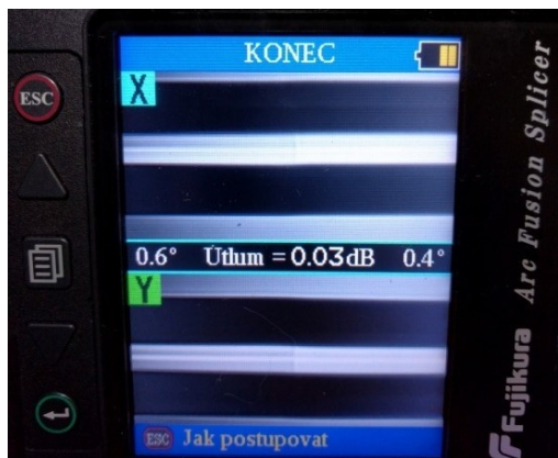
Obr. 35. Výsledok zväracieho procesu.
