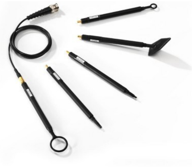
Obrázek 9: Set sond RS HZ-15 (ilustrační foto)
