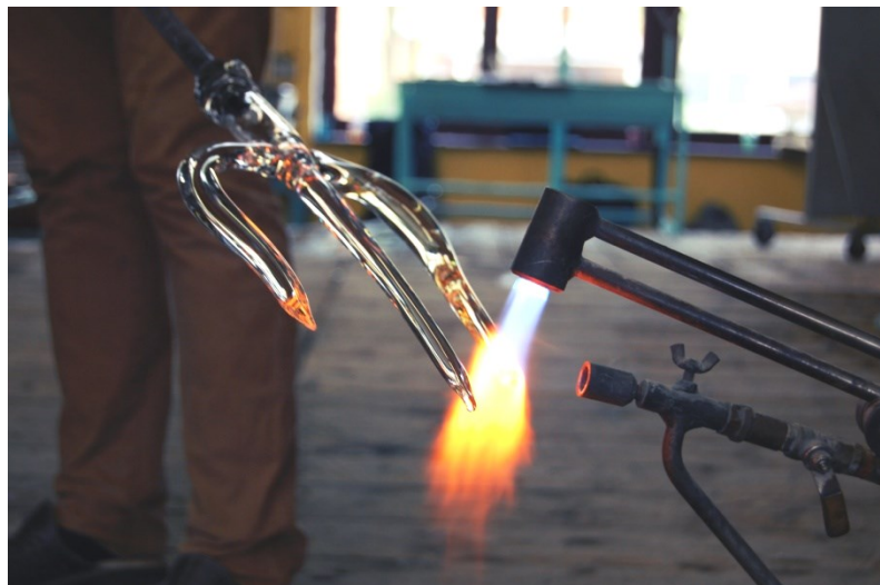
Obr. 77 Hutní tvarování vidlí
