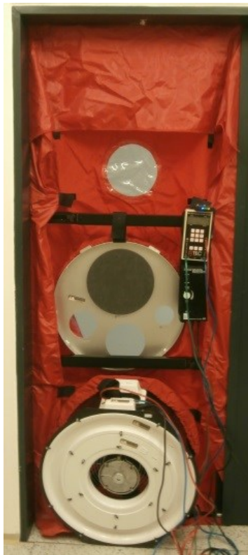
Obr. 10. Odebrání clon před druhou sérií měření [Zdroj: vlastní]
