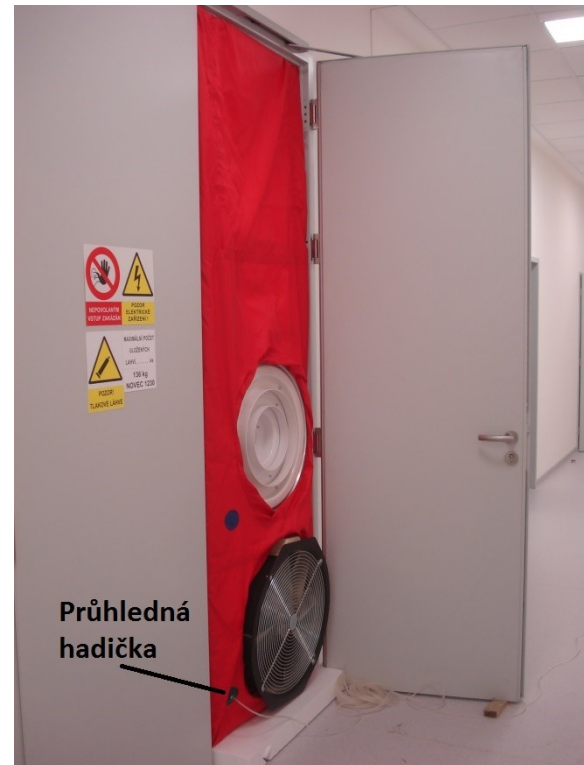
Obr. 7. Průhledná hadička zapojená v průchodce plachty [Zdroj: vlastní]
