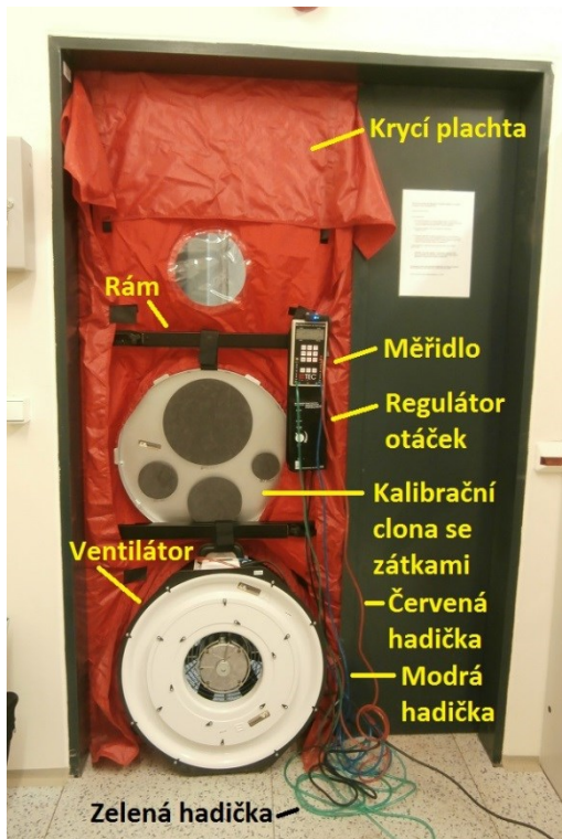
Obr. 6. Měřicí sestava s jednotlivými komponenty [Zdroj: vlastní]
