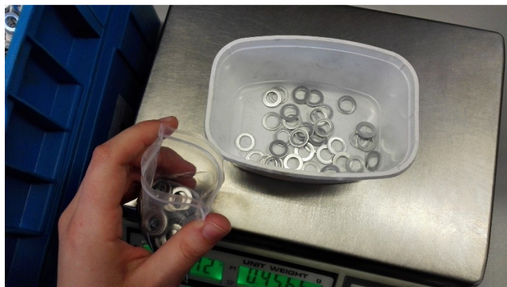
Obrázok 40 – Nevyhovujúca krabička na naplňovanie ZIP vreciek (vlastné spracovanie)
