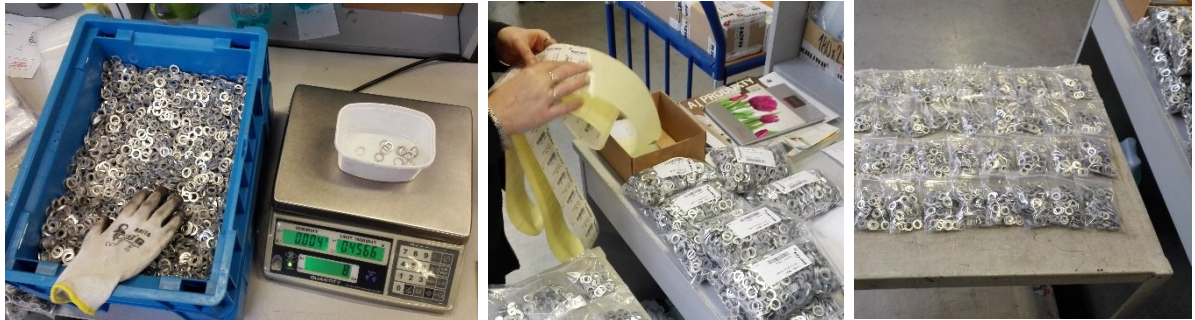
Obrázok 41 – Ručné váženie a lepenie štítkov na ZIP vrecká (vlastné spracovanie)
