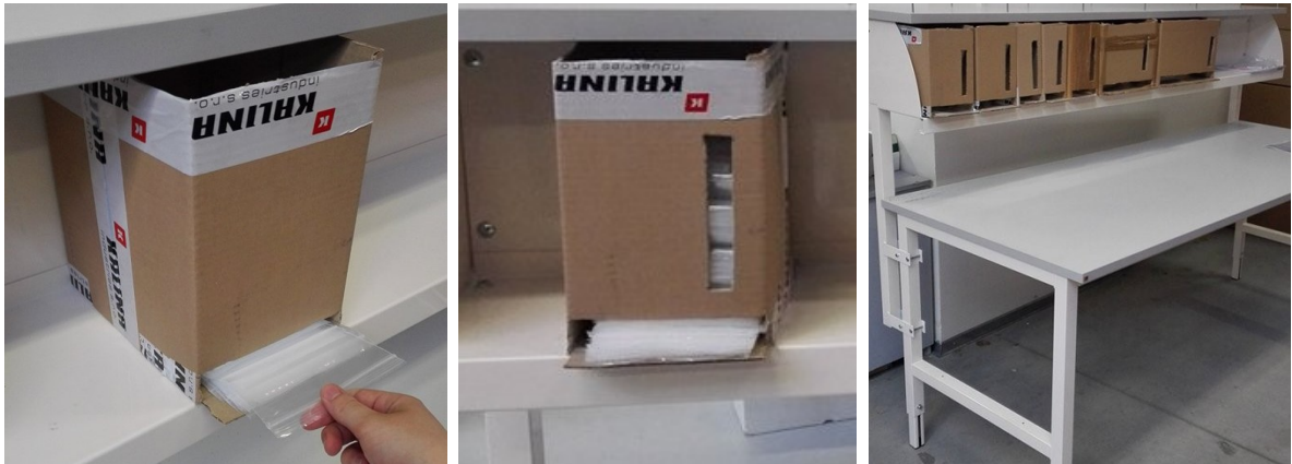
Obrázok 54 – Kartónový návrh a testovanie fungovania zásobníka (vlastné spracovanie)
