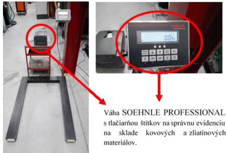
Obrázok 26 – Váha na naskladňovanie a vyskladňovanie kovového materiálu (vlastné spracovanie)
