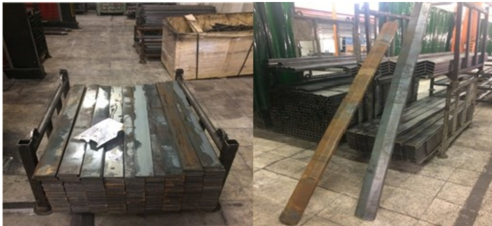
Obr. 36. Materiál poničený vlivem nevhodného skladování (Vlastní zpracování)
