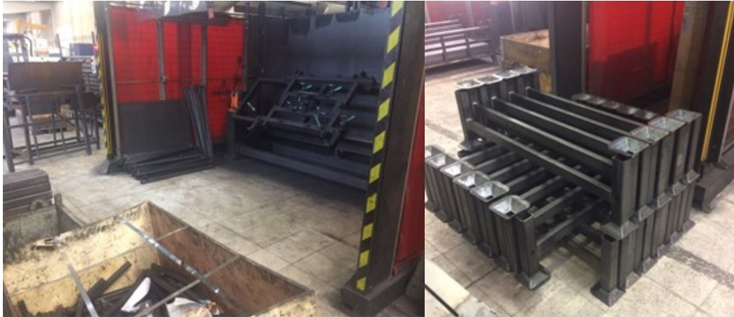
Obr. 25. Přední polohovadlo na robotu ABB (Vlastní zpracování)
