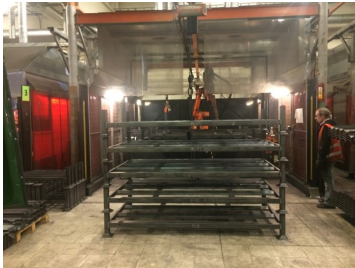
Obr. 26. Hotové svařené základny (Vlastní zpracování)
