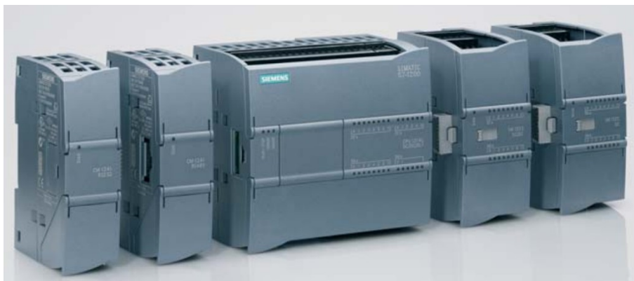
Obr. 16 Rozšíření Simatic S7-1200 o signální komunikační moduly [12]
