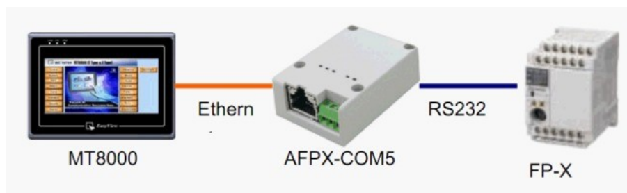
Obr. 14 HMI – Ukázka komunikace s PLC [8]
