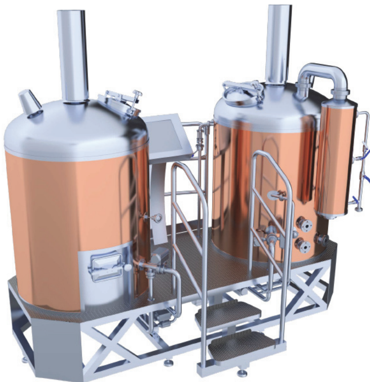
Obr. 48. Celkový návrh varny – pohled ze strany obsluhy
