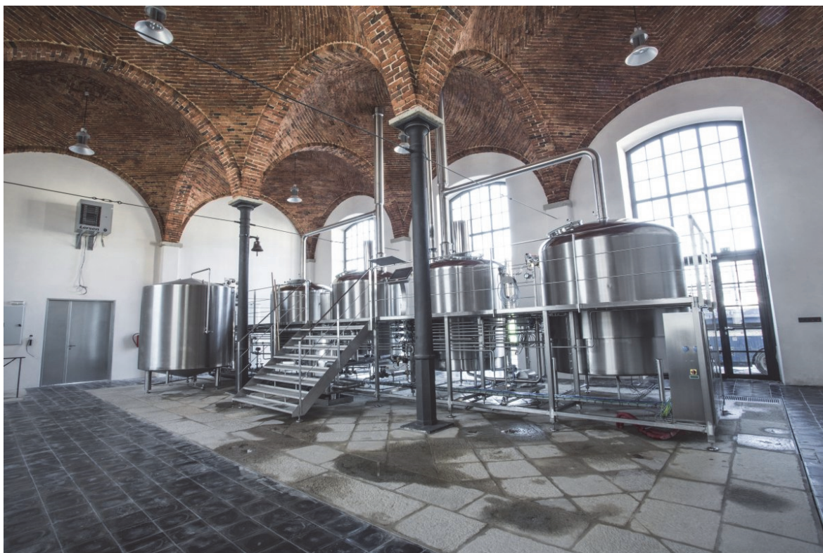
Obr. 3. Čtyřnádobová varna pro var 30hl s nádobou horké vody v pivovaru Kamenice nad Lipou [7]
