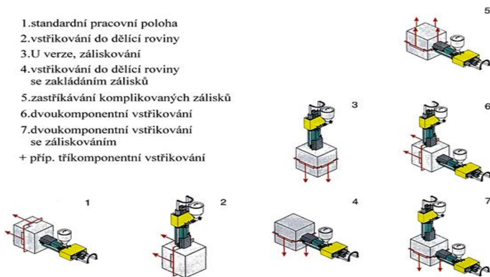
Obr. 15 Vzájemné polohy mezi vstřikovací a uzavírací jednotkou [21]
