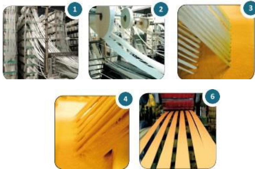
Obr. 19 1.) Zásobník výztuží, 2.) Naváděcí zařízení, 3.a 4.) Proces smáčení, 6.) Tažná sekce a řezání materiálu [20]
