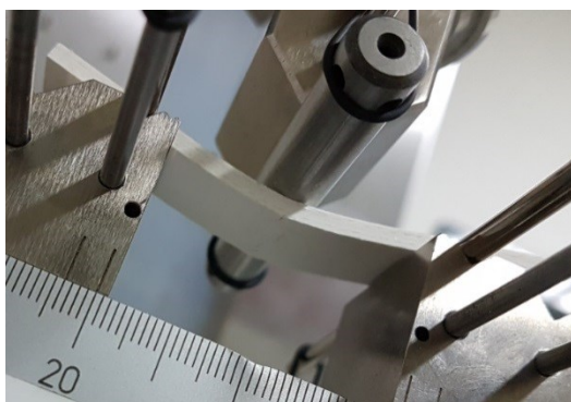
Obr. 34 Zkušební vzorek s porušením na tahové straně ve směru příčném vůči směru tažení při pultruzi
