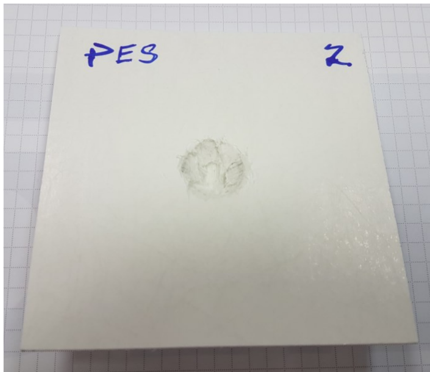
Obr. 52 Zkušební vzorek 1/2 (lícová strana) po zkoušce s polyesterovou matricí se skleněnou výztuží
