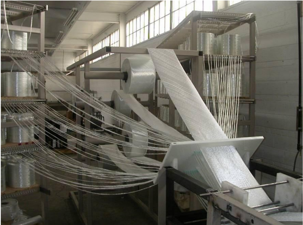
Obr. 25 Výrobní linka (umístění a navádění rohoží, rovingů) [29]
