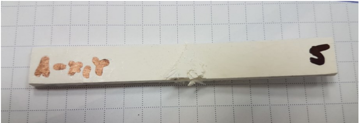
Obr. 44 Příklad poruchy vzorku s akrylátovou matricí se skleněnou výztuží po dopadu kladiva v souřadnicovém systému X, Y (edgewise – dopad na hranu)
