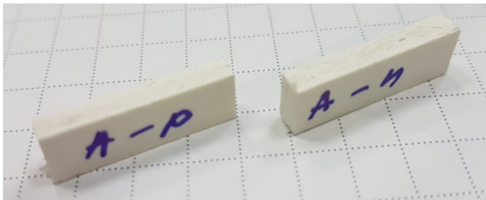
Obr. 41 Zkušební vzorky s akrylátovou matricí se skleněnou výztuží po zkoušce ve směru podélném a příčném vůči směru pultruze
