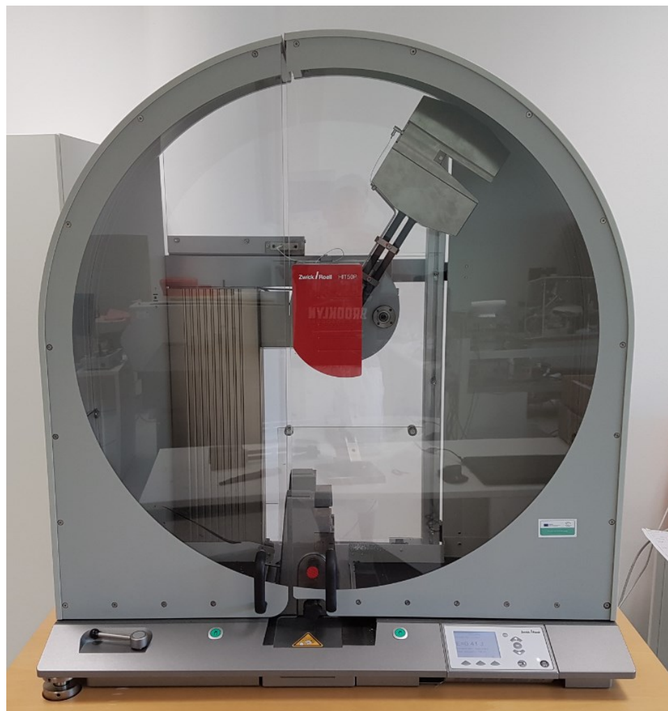
Obr. 31 Testovací stroj ZWICK/ROELL HIT 50 P
