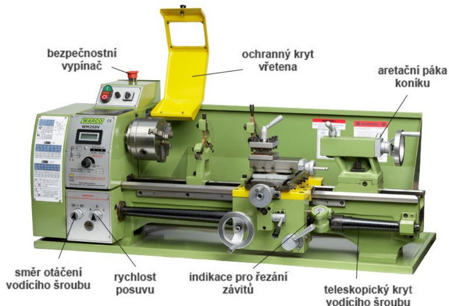
Obr. 4. Části universálního hrotového soustruhu [5]
