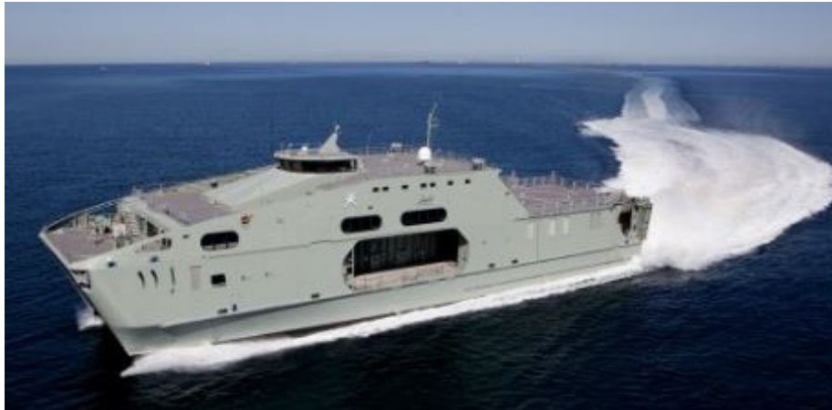
Obr. 27 Univerzální loď "Austal HSSV 72" vytvořena zejména pomocí hliníkových voštin. [29]
