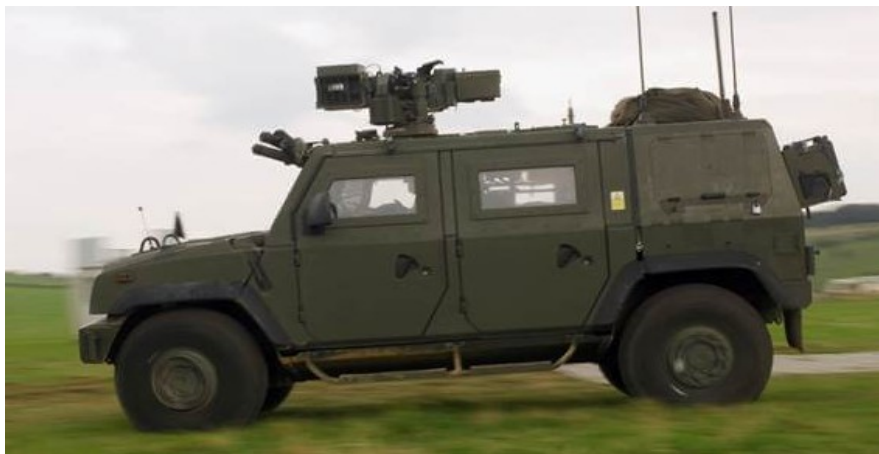
Obr. 29 Vojenské vozidlo "Panther Command Vehicle" se speciálním podvozkem z hliníkové voštiny odolné proti výbušninám. [24]
