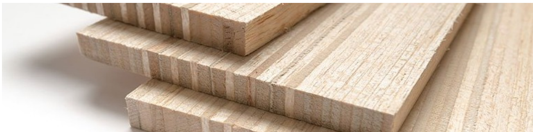
Obr. 7 Dýha balzového dřeva. [20]
