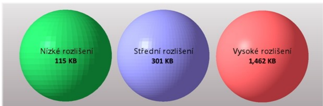
Obr. 19 Srovnání kvality povrchu a velikosti souboru STL [29]
