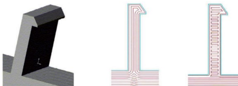
Obr. 17 Rozdílnost způsobů kladení vrstvy materiálu [39]
