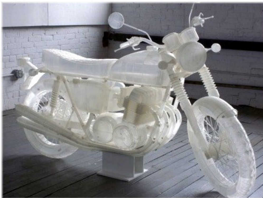
Obr. 12 Model motocyklu v měřítku 1:1 vyrobený tiskárnami Ultimaker [27]
