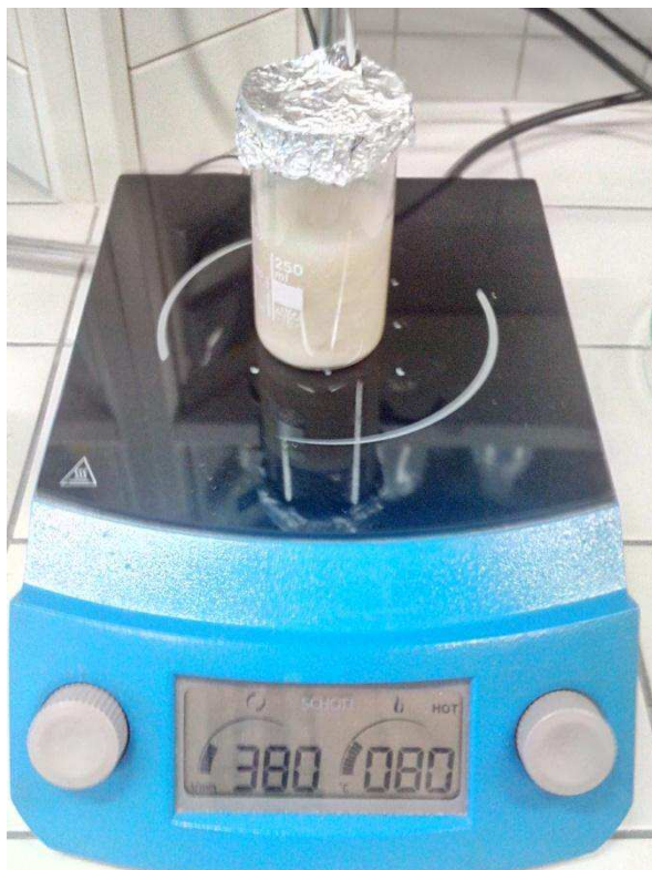
Obr. 10: Extrakce želatiny na topné desce
