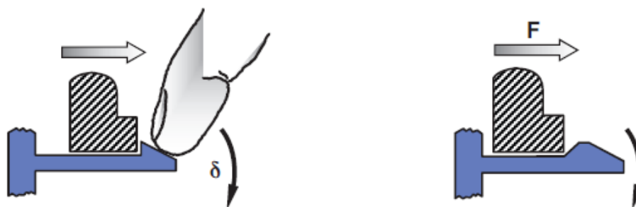
Obr. 24 Manuálně rozebíratelný spoj a samo rozebíratelný spoj (10)
