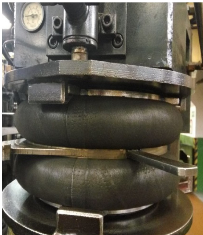
Obr. 26. Bombírování konfekce vzduchové pružiny
