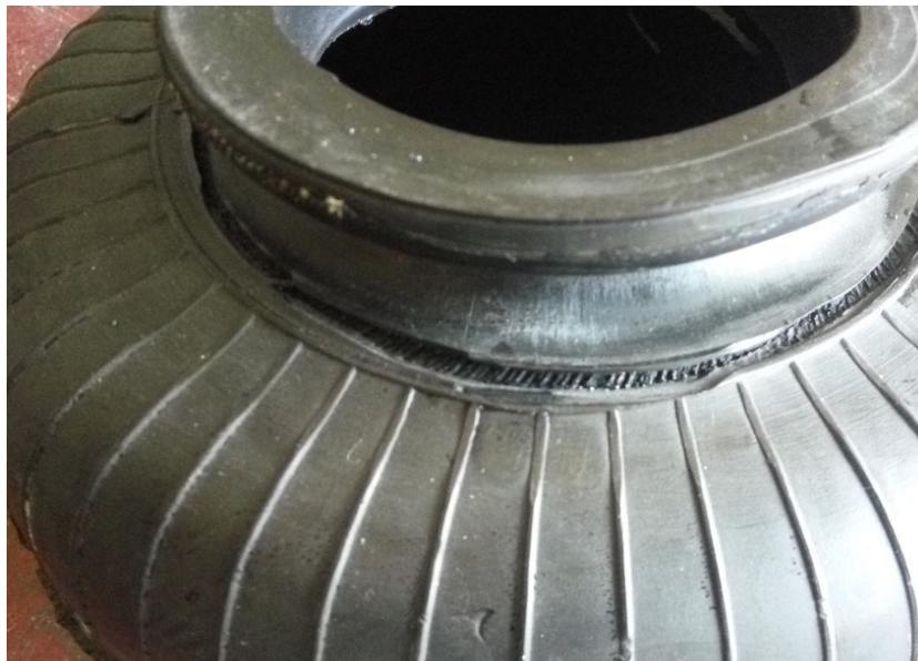
Obr. 38. Příklad prořezání okrajů kordů skrz vrchní pryžovou folii
