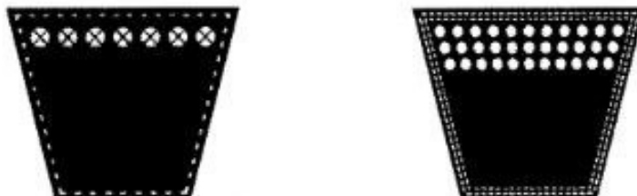
Obr. 18. Průřez obalovaným klínovým řemenem, s provazci a jedním obalem (vlevo), s kordem a dvěma obaly (vpravo) [7]
