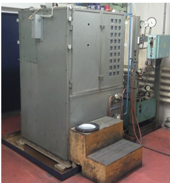
Obr. 34. Zkušební (bezpečnostní) box destrukční zkoušky
