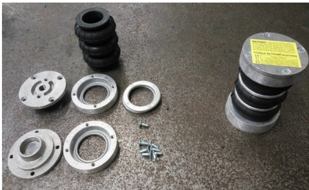
Obr. 28. Vzduchová pružina s kovovými díly ke kompletaci (vlevo), zkompletovaná vzduchová pružina (vpravo)
