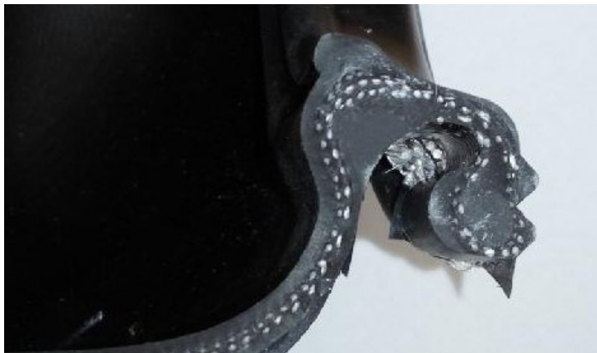
Obr. 32. Vada výlisků - nadbytek materiálu
