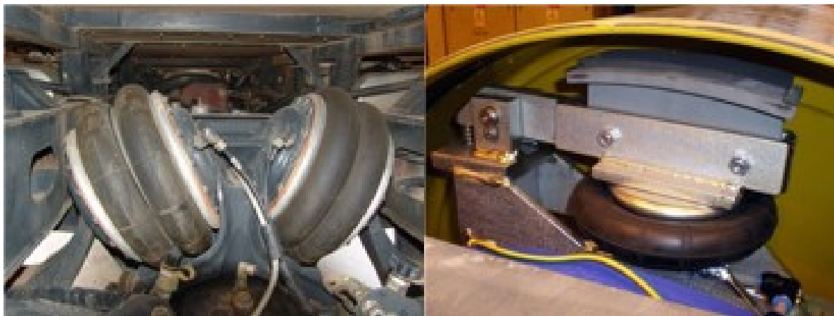
Obr. 12. Odpružení kol vozidel Tatra (vlevo) , brzda válce (vpravo) [4]
