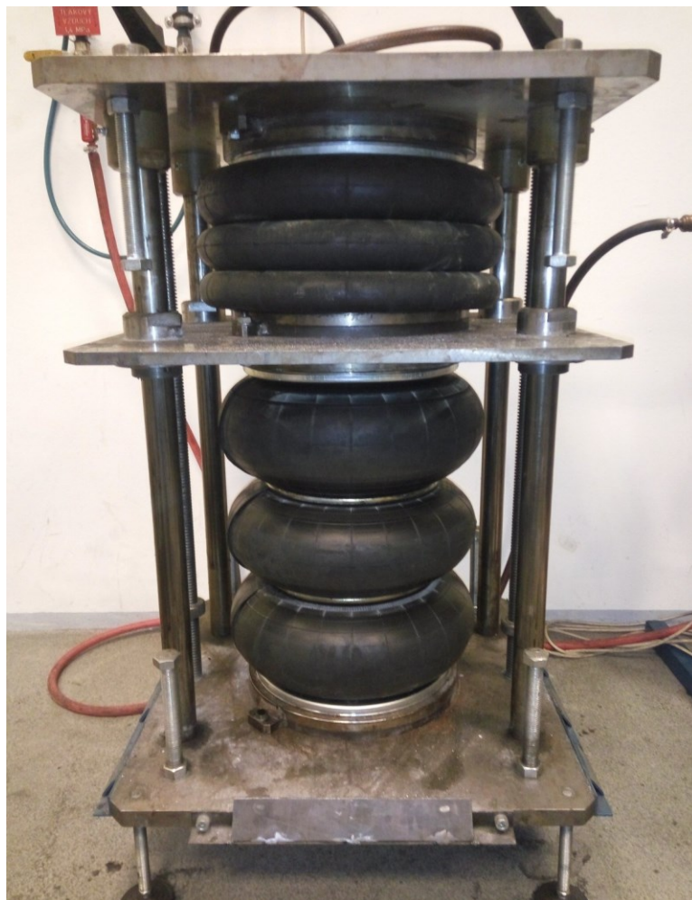
Obr. 37. Umístění vzduchových pružin (14x3 2ply) při provozní zkoušce. Horní pružina v poloze H_{min} , spodní v poloze H_{max}
