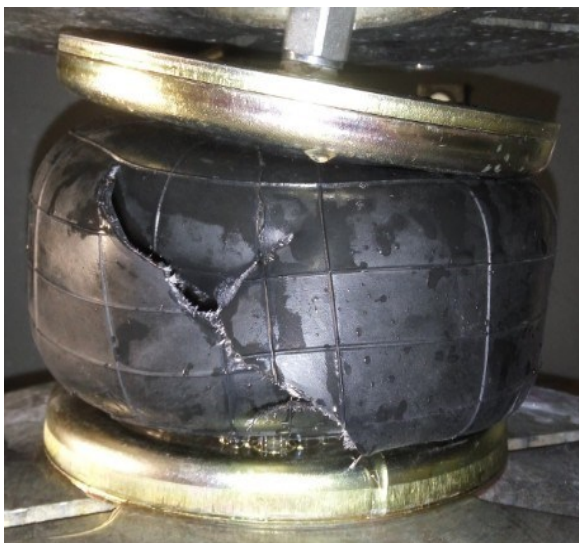
Obr. 36. Detail roztržení kordů vzduchové pružiny
