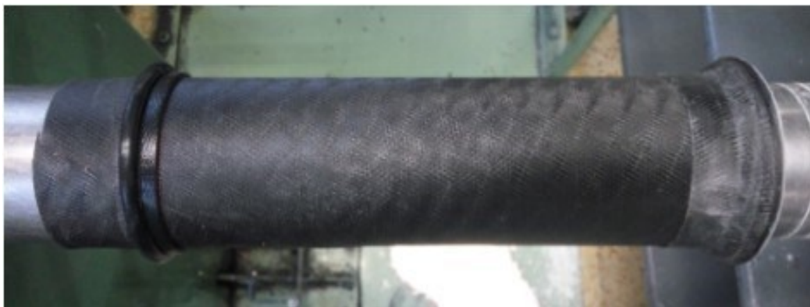
Obr. 25. Konfekce na konfekčním trnu. Na levé straně neotočený pogumovaný kord kolem patky, vpravo otočený a vyválcovaný pogumovaný kord kolem patky.
