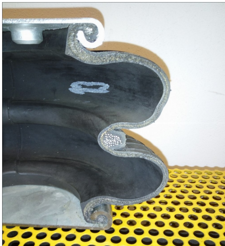
Obr. 10. Řez vlnovcem vzduchového pružení
