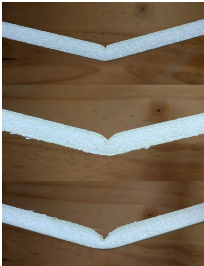
Obr. 33 Zkušební vzorky (shora: vzorek skupiny 1_p_1_ohyb, 2_p_2_ohyb a 3_p_3_ohyb). [vlastní]
