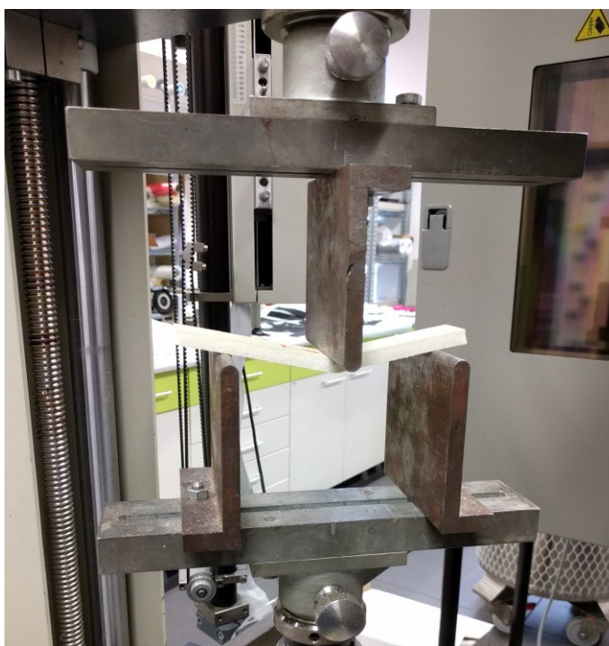
Obr. 25 Čelisti pro zkoušku tříbodovým ohybem. [vlastní]
