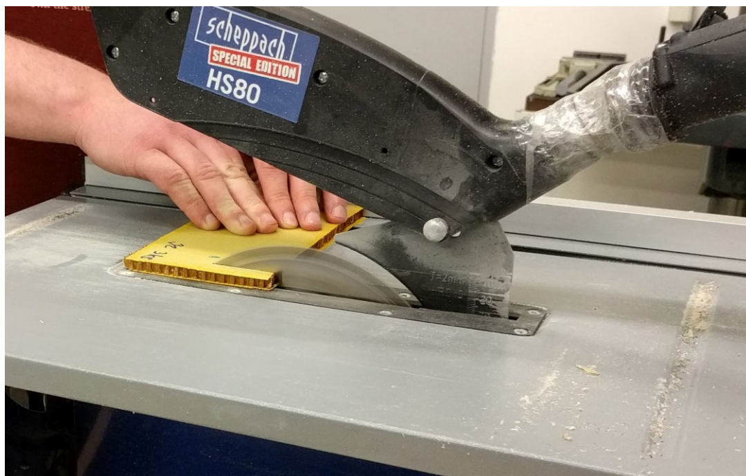
Obr. 24 Řezání vzorků. [vlastní]
