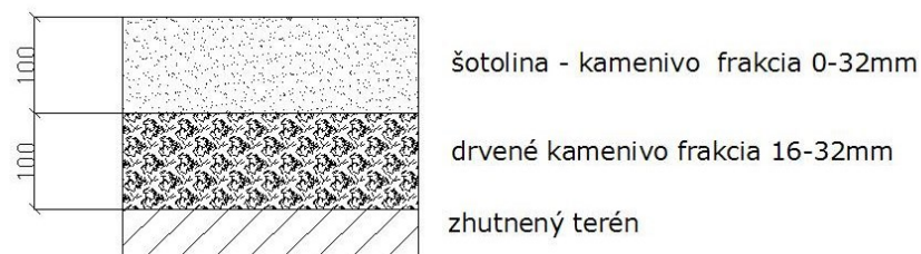
Obr. 10 profil mlatového chodníka
