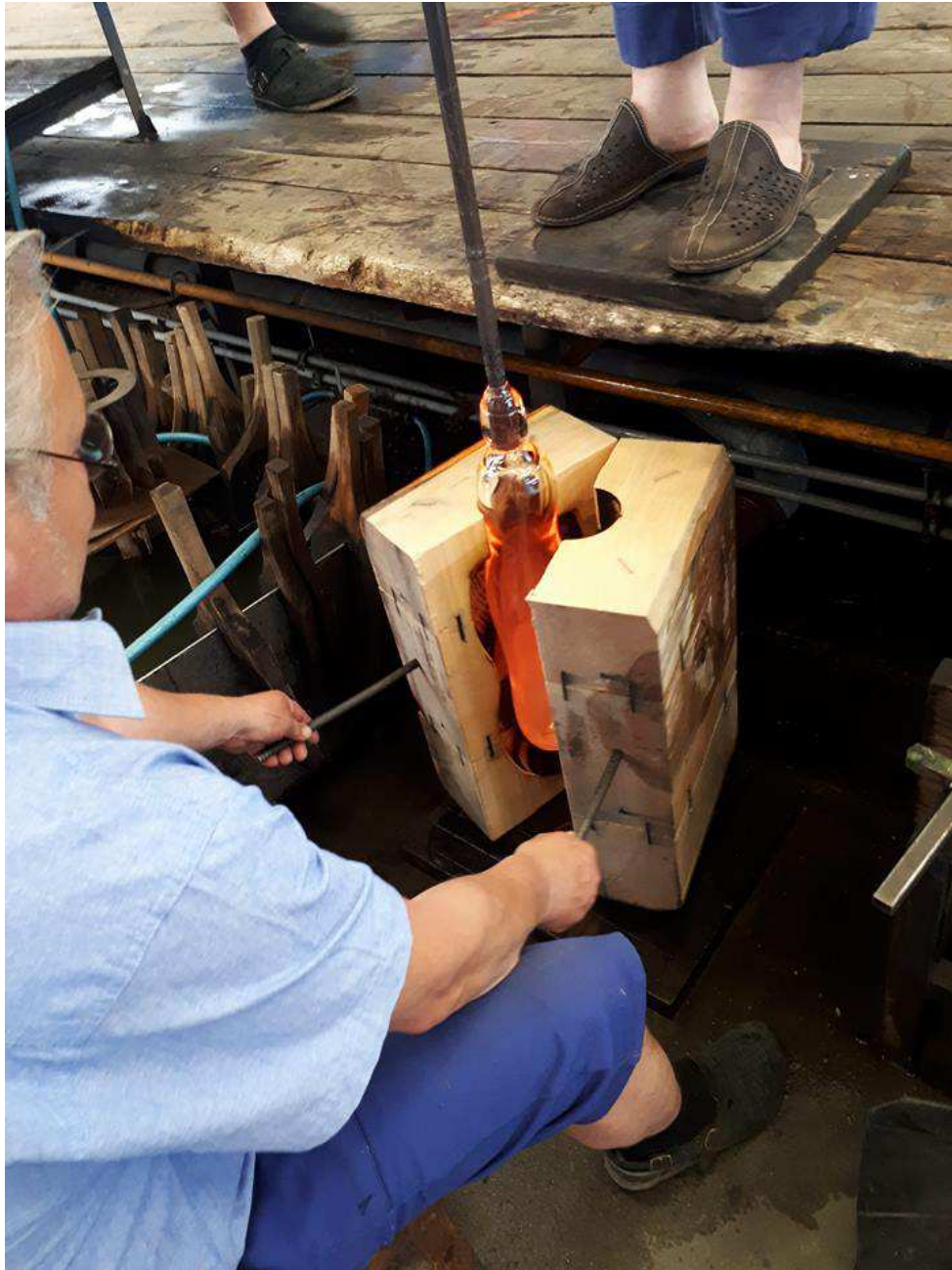
Obr. 53 Uzavírání formy a foukání
