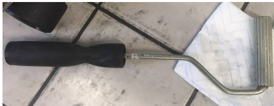
Obr. 55 Kovový váleček k prosycení pryskyřice tkaninou
