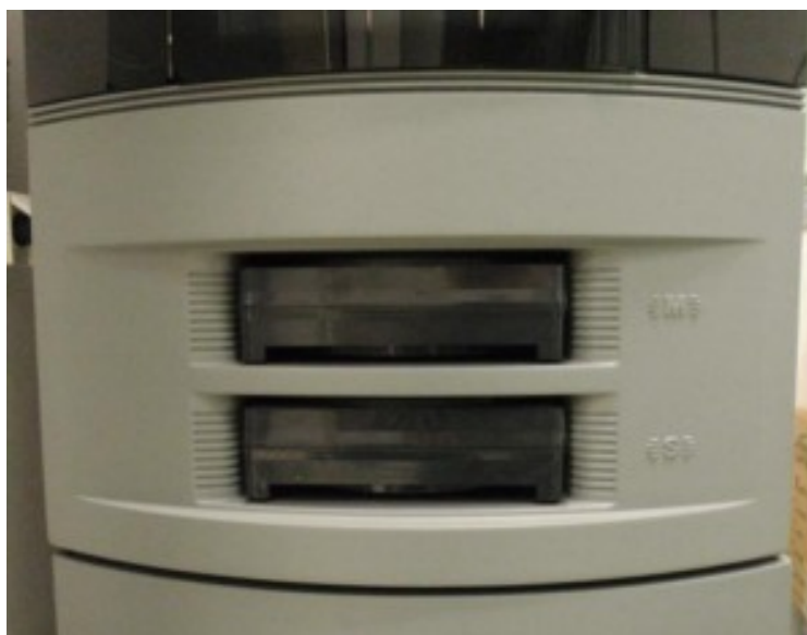
Obr. 24 Ukázka uložení kazet uvnitř tiskárny
