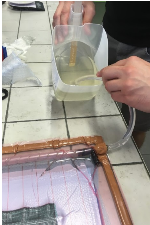
Obr. 47 Detail nasávání pryskyřice do formy
