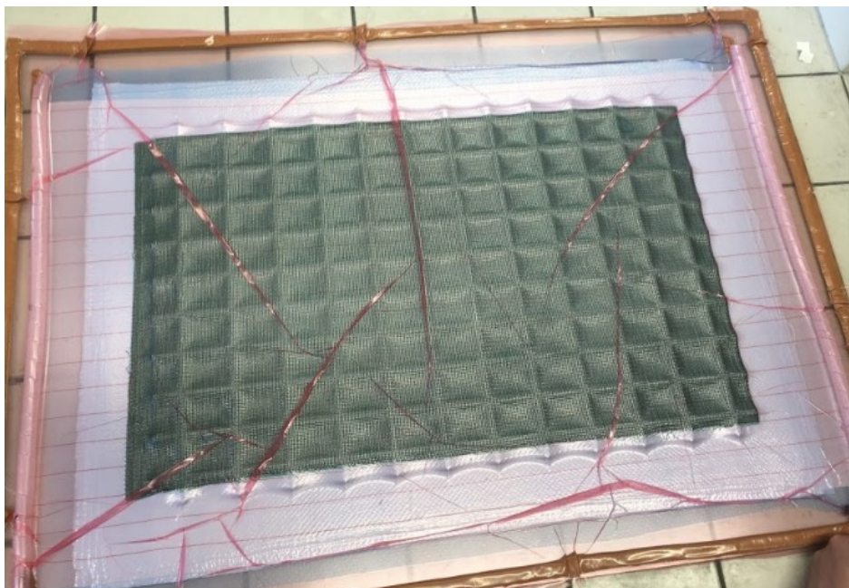
Obr. 46 Pohled na kompletní zavakuovanou formu
