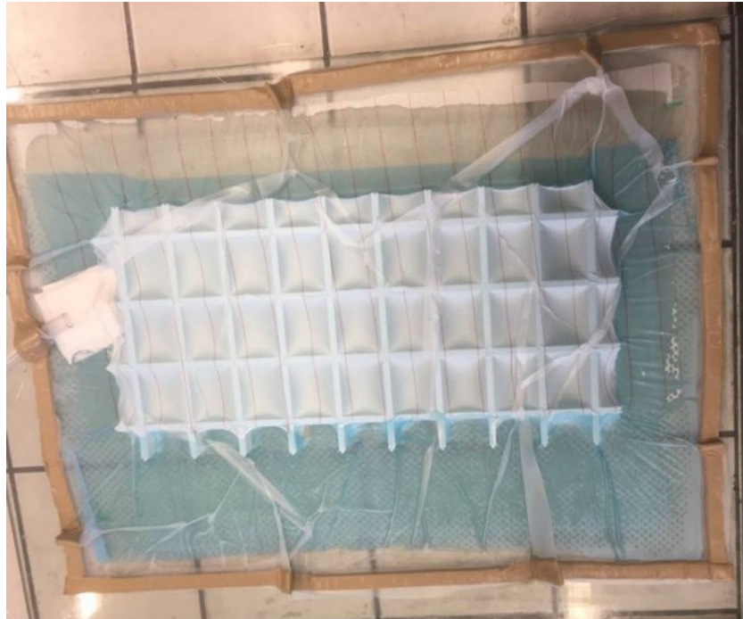
Obr. 57 Pohled na kompletní zavakuovanou formu
