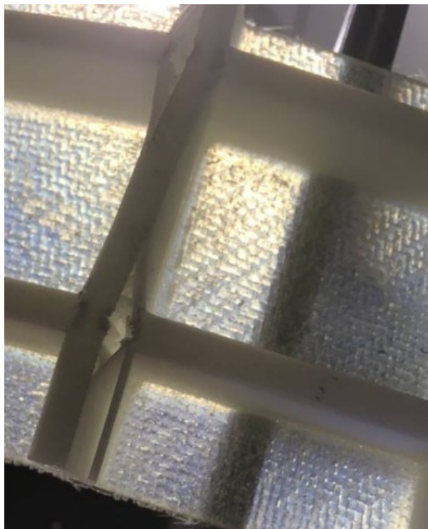
Obr. 71 Prasknutí žebër u vzorku č. 6
