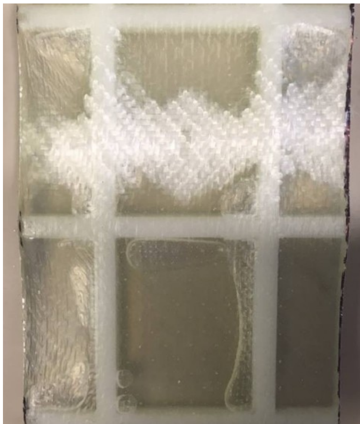
Obr. 68 Vzorek č. 3 po zkoušce tříbodovým ohybem
