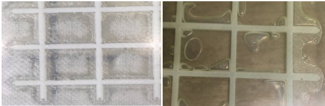
Obr. 54 Prosycení vzorku s výškou 2 mm vlevo a vzorku s výškou 5 mm vpravo
