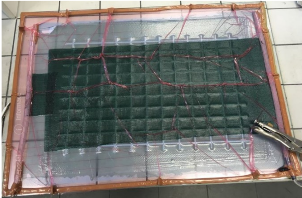
Obr. 52 Pryskeřící prosycená forma
