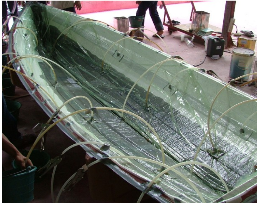
Obr. 20 Vakuová infuze- výroba trupu lodě [31]
