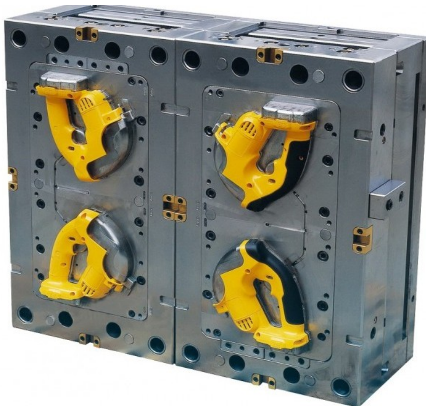
Obr. 4. Vstřikovací forma pro více-komponentní vstřikování [26]
