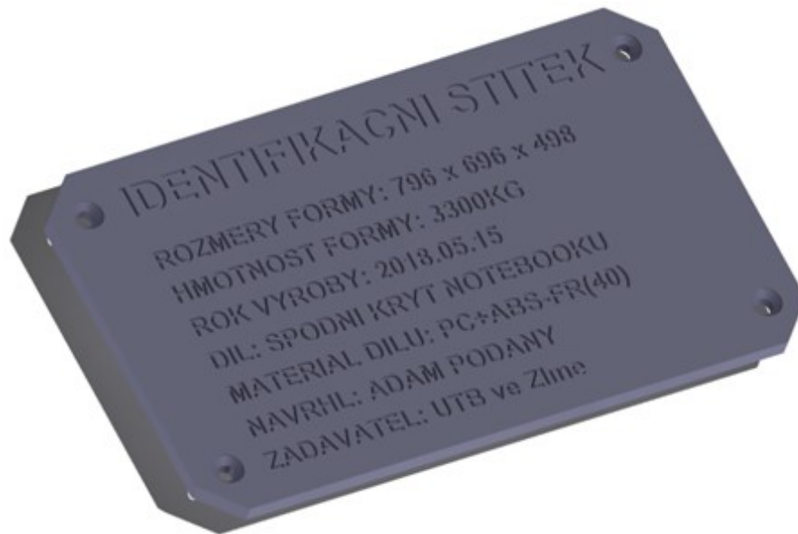
Obr. 52. Identifikační štítek formy
