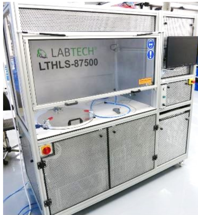
Obr. 6.2 Heliová stanice pro detekci netěsnosti.
