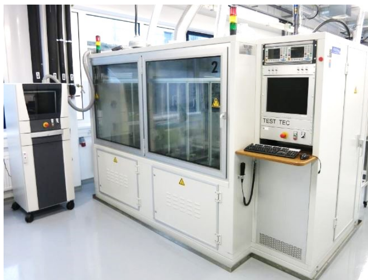
Obr. 6.1 Nízko frekvenční pulzační stanice.
