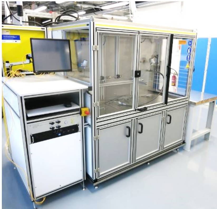
Obr. 6.5 Stanice pro měření ztrátového tlaku.
