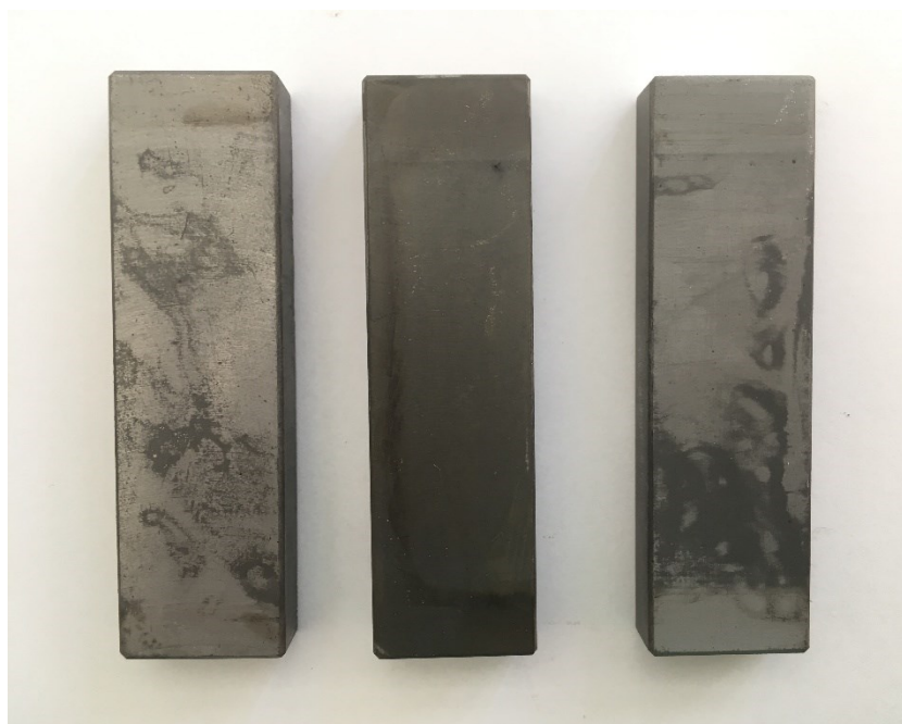
Obr. 9. Použité destičky ze slitin hliníku s povrchovou vrstvou PVD
