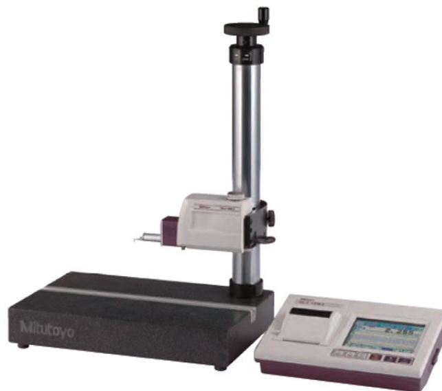
Obr. 11 Drsnoměr Mitutoyo SJ 401 [28]
