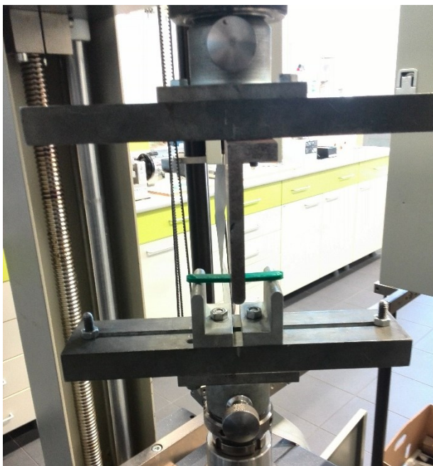
Obr. 27: Způsob uchycení při ohybové zkoušce
