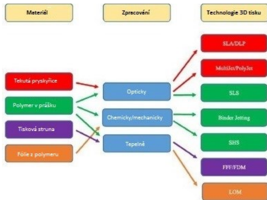
Obr. 2: Přehled typů monomerních / polymerních materiálů, způsoby zpracování a aditivní výrobní metody 3D tisku [40]
