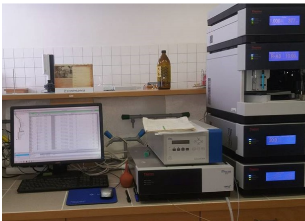
Obrázek 3 – Kapalinový chromatograf Dionex Ultimate 3000
