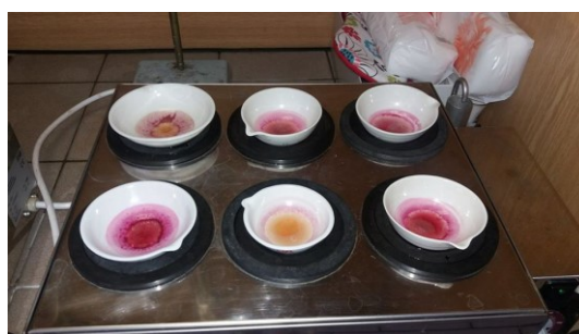
Obrázek 6 – Odpařování vzorků při extrakci
