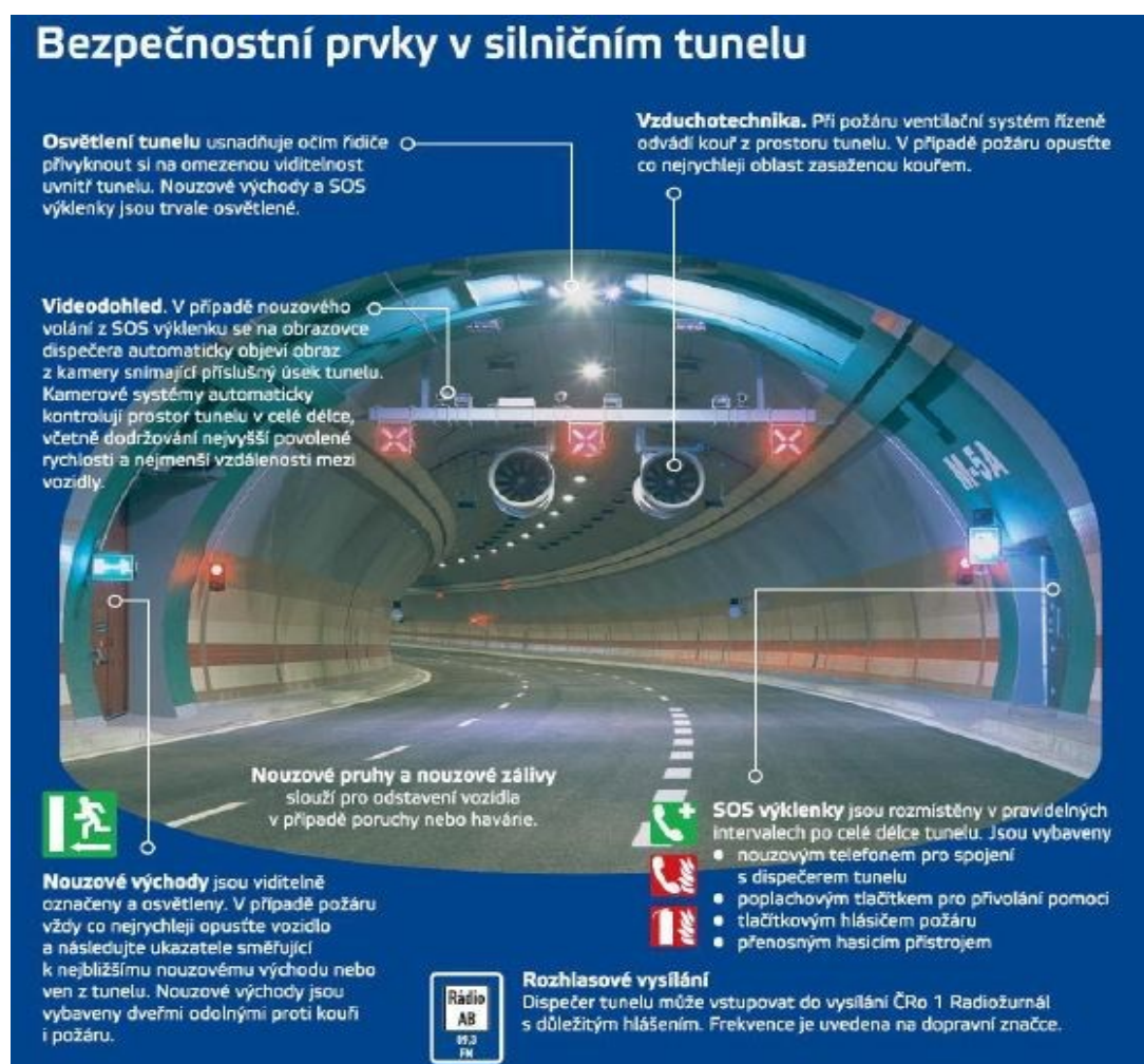
Obrázek 7 Bezpečnostní prvky tunelu [7]
