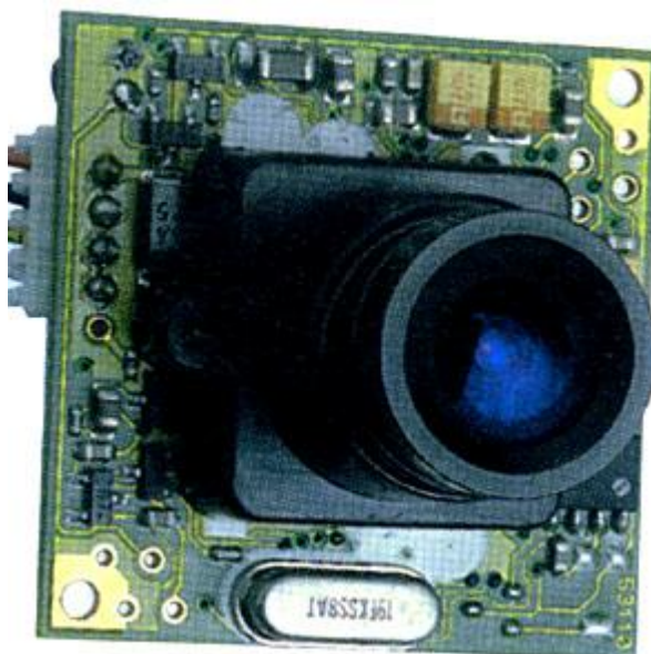
Obr. 23 CCD kamera VCM 36
