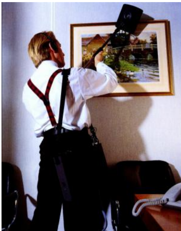
Obr. 44 Použití detektoru nelineárních přechodů
