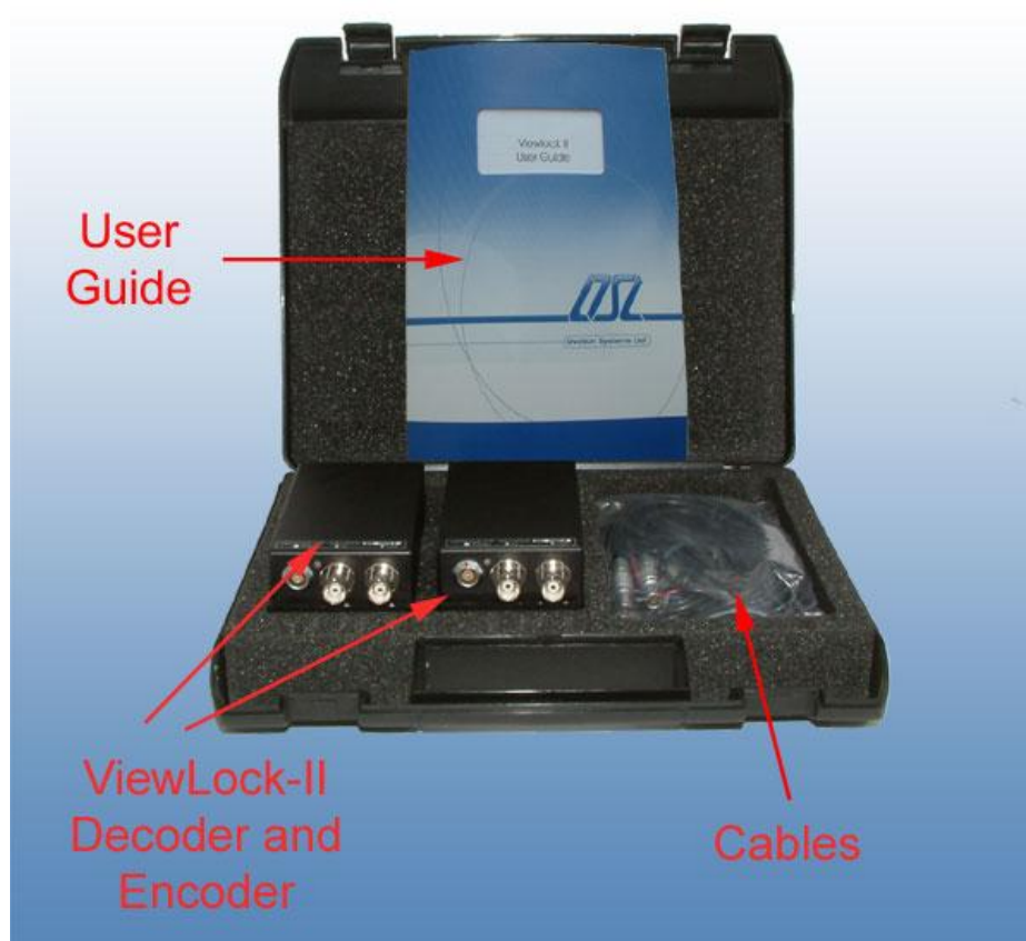
Obr. 31 Sada kodéru a dekodéru ViewLock
