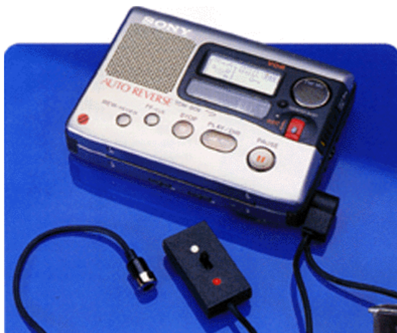
Obr. 3 Souprava drátového mikrofonu a citlivého předzesilovače BW80
