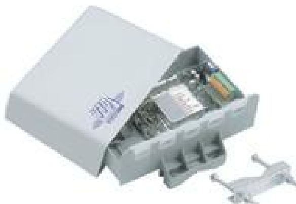
Obr. 29 PROOUT-R venkovní přijímač
