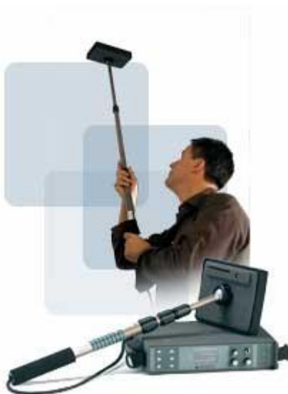
Obr. 33 Detektor nelineárních přechodů
