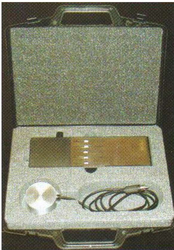
Obr. 5 Kontaktní mikrofon se zesilovačem
