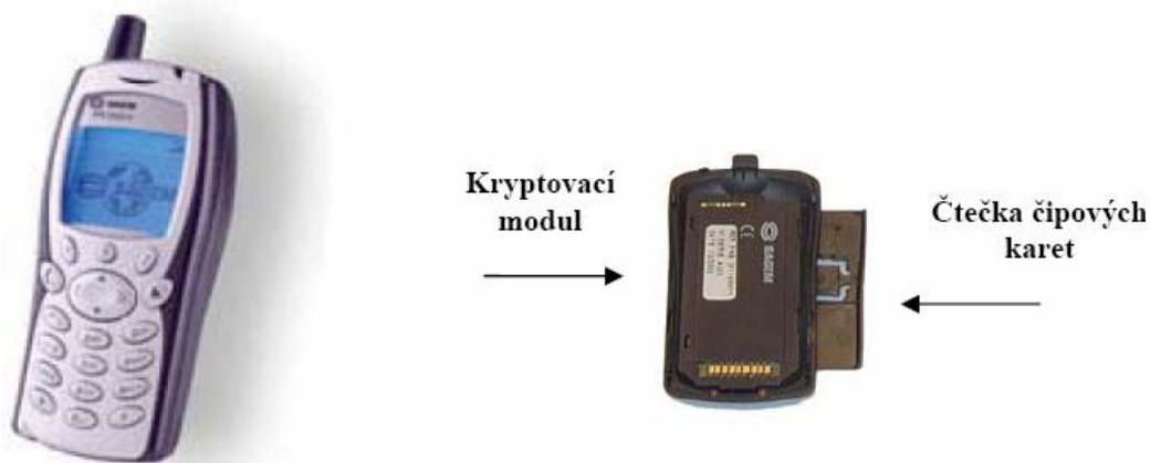
Obr. 37 MW 3026 S - přední strana mobilního telefonu a kryptovací modul.
