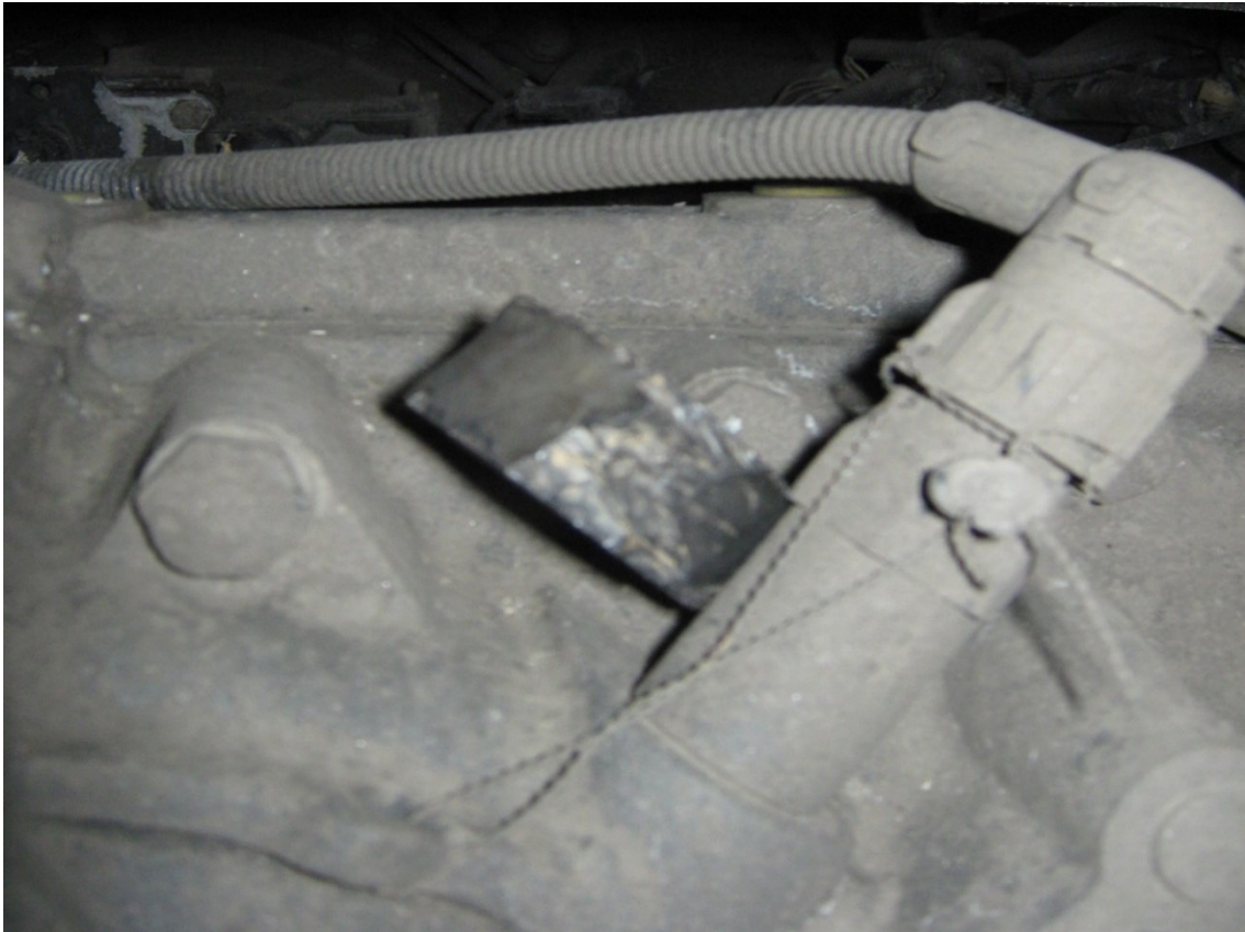
Obrázek 3 Magnet na snímači rychlosti [vlastní zpracování]
