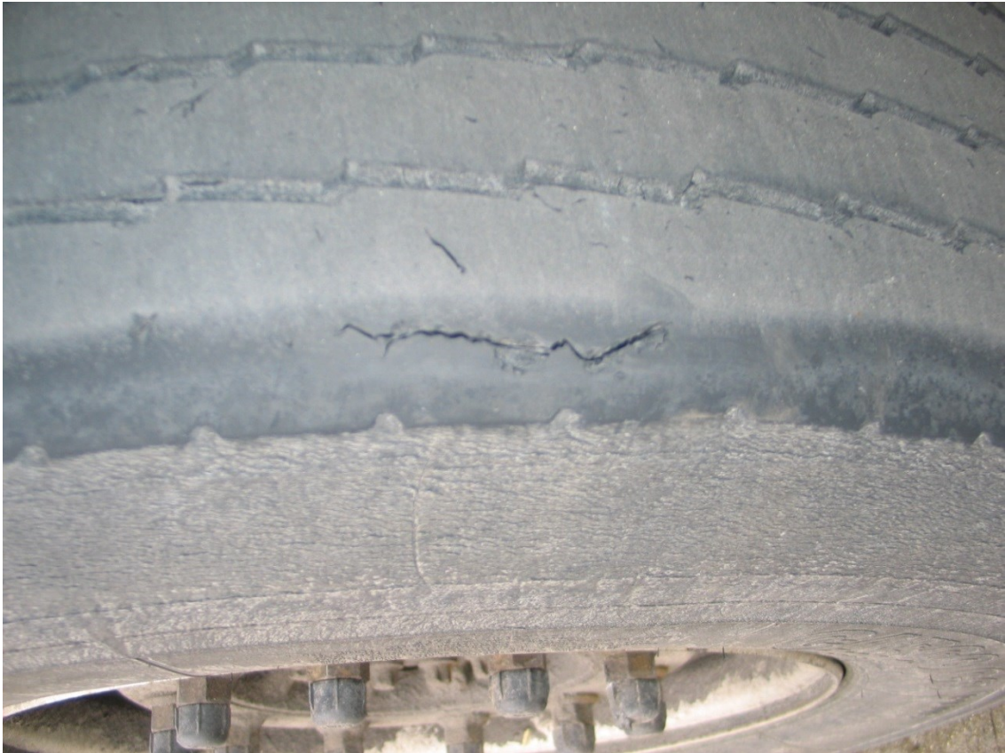
Obrázek 4 Špatný technický stav pneumatiky [vlastní zpracování]
