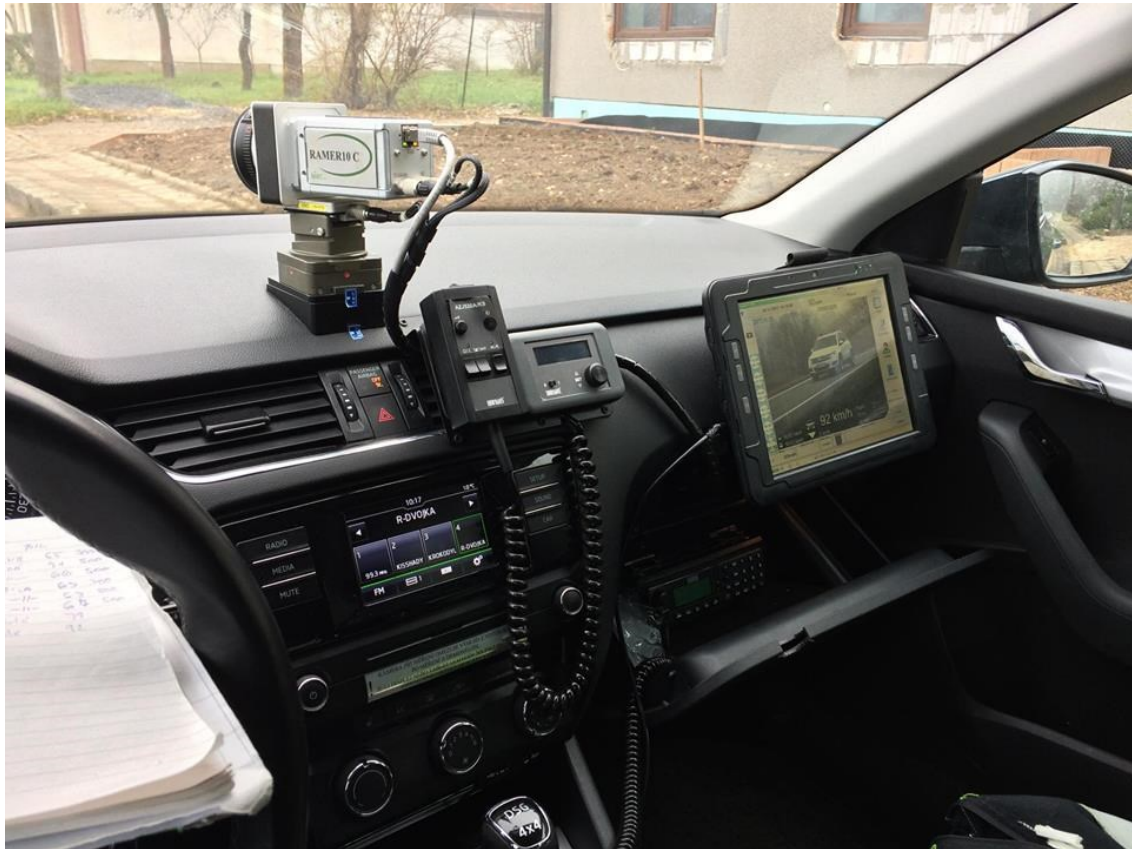
Obrázek 1 Měření rychlosti přístrojem RAMEO AD 10 [vlastní zpracování]
