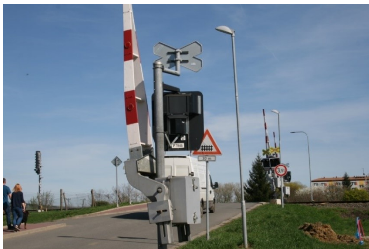
Obrázek 9: Identifikační číslo přejezdu na světelné skříně. [Zdroj: vlastní]
