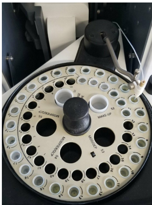
Obrázek 14 Rozložení jednotlivých mineralizovaných vzorků písku, půdy, standartu a destilované vody na karuselu přístroje Agilent Duo 240FS/240Z [Zdroj: Vlastní].
