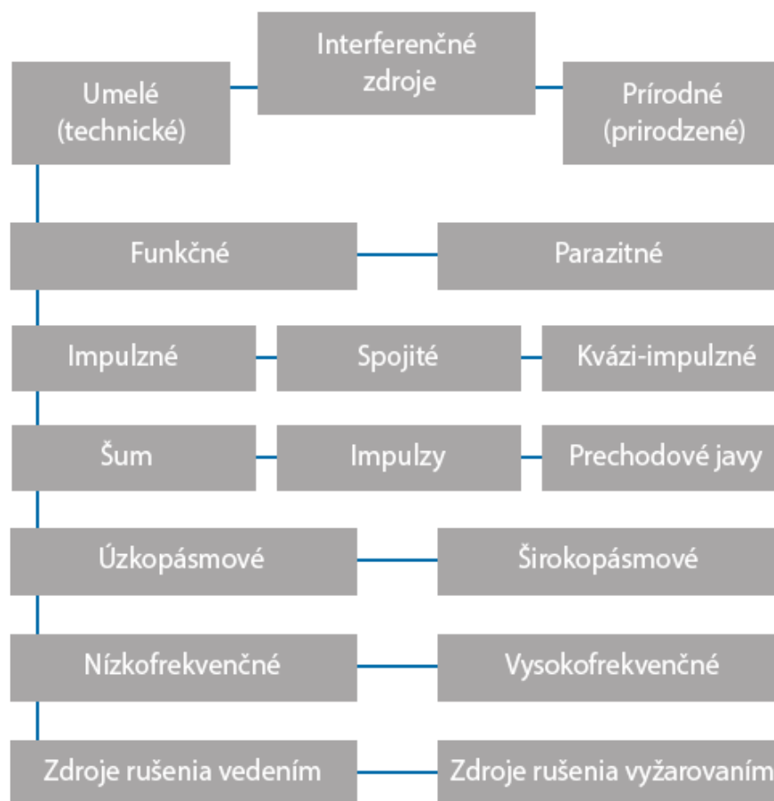
Obr. 5 – Klasifikácia interferenčných zdrojov [1]
