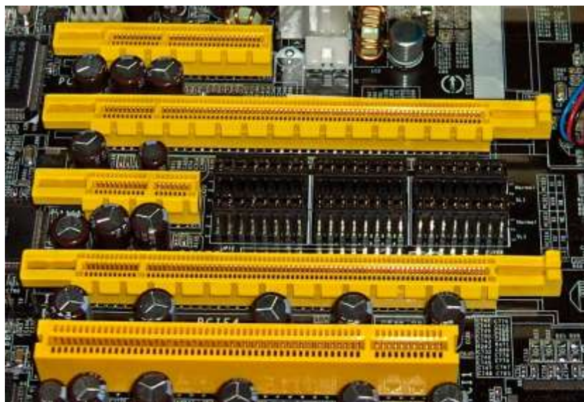
Obr. 30 – PCIe sloty – x4, x16, x1, x16, expanz. PCIe (32bit,5V) [18]
