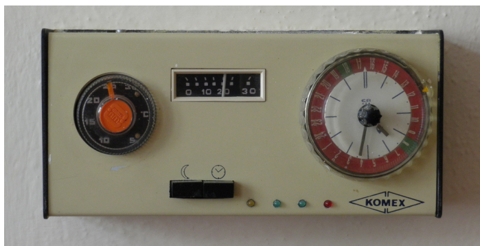
Obr. 5.2 Pokojový termostat Komextherm
