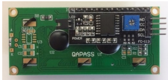
Obr. 6 LCD displej s I 2 C modulom
