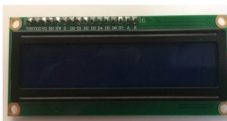
Obr. 5 LCD displej s rozlíšením 16x2 znakov
